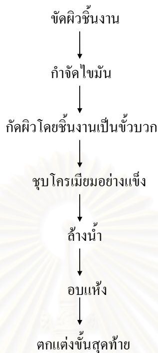
รูปที่ ก.4 แสดงขั้นตอนการชุบโครเมียมอย่างแข็ง
