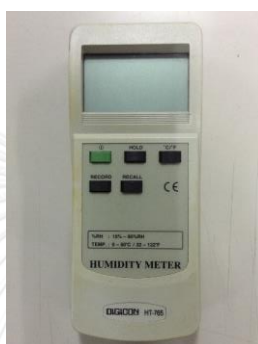
รูปที่ 4 - 12 เครื่องวัดความชื้นยี่ห้อ Digicon รุ่น HT-765
