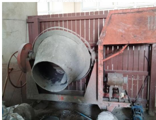
รูปที่ 3.11 เครื่องผสมคอนกรีตขนาด 1.2 ลูกบาศก์เมตร
