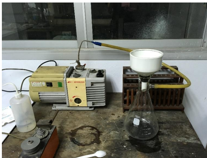
รูปที่ 3.7 เครื่อง suction สำหรับทดสอบการอุ้มน้ำของมอร์ตาร์เสริมเส้นใย
