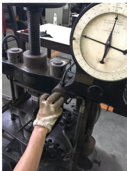
รูปที่ 3.5 การทดสอบกำลังรับแรงอัดของก้อนลูกบาศก์ตัวอย่าง
