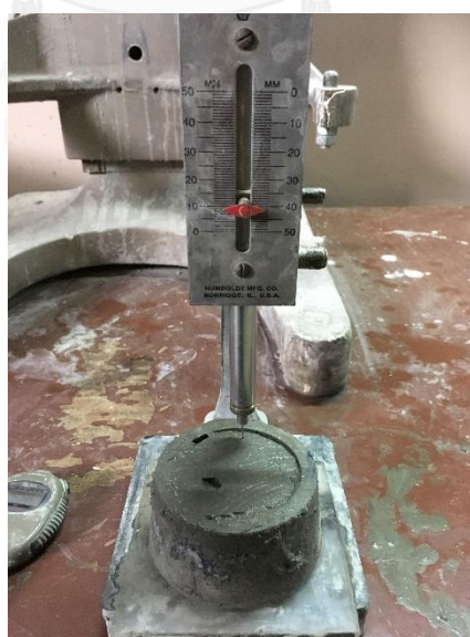
รูปที่ 3.8 การทดสอบการก่อตัวของมอร์ตาร์เสริมเส้นใย
