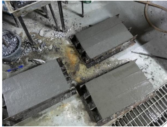
รูปที่ 3.10 ขนาดของตัวอย่างคานทดสอบ 100x100x500 มิลลิเมตร
