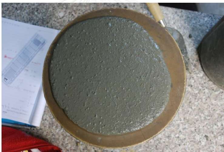
รูปที่ 3.6 การทดสอบค่าการไหลผ่านของมอร์ตาร์เสริมเส้นใย
