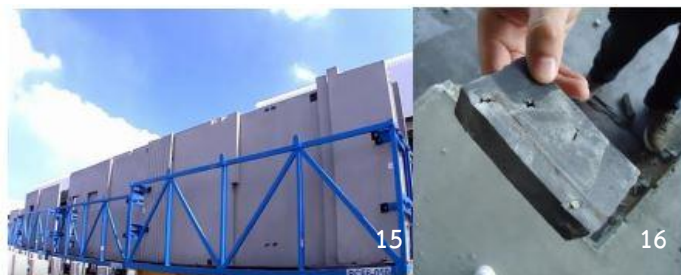
รูปภาพที่ 38 ตะกร้าวางแผ่นคอนกรีตเตรียมการขนส่งของโรงงานพุกาษา พรีคาสท์ นวนคร ที่มา : ผู้วิจัย, 2558
