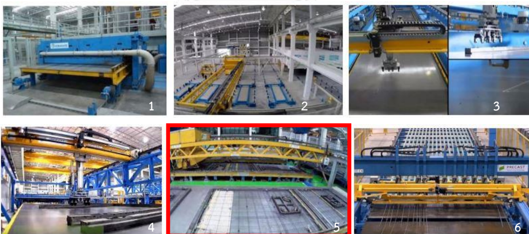
รูปภาพที่ 36 ขั้นตอนการผลิตห้องน้ำสำเร็จรูปแบบแยกชิ้นส่วน โรงงานพุกษา พรีคาสท์ นวนคร
