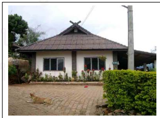
รูปที่ 5.27 ตัวอย่างบ้านที่ใช้วัสดุแบบสมัยใหม่ คือ หลังคากระเบื้อง โครงสร้างหลักและผนังอิฐบล็อกฉาบเรียบ ทาสี หน้าต่างบานเกล็ด
