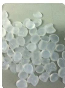
รูปที่ 2-9 ตัวกลางโคอะเลสเซอร์ชนิดต่าง ๆ
