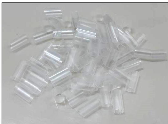
รูปที่ 3-4 วัสดุที่ใช้เป็นตัวกลางโคอะเลสเซอร์
