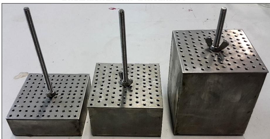
รูปที่ 3-5 ชั้นตัวกลางโคอะเลสเซอร์
