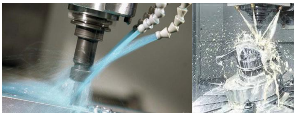
รูปที่ 2-8 การใช้น้ำมันตัดในอุตสาหกรรมตัดกลึงโลหะ
