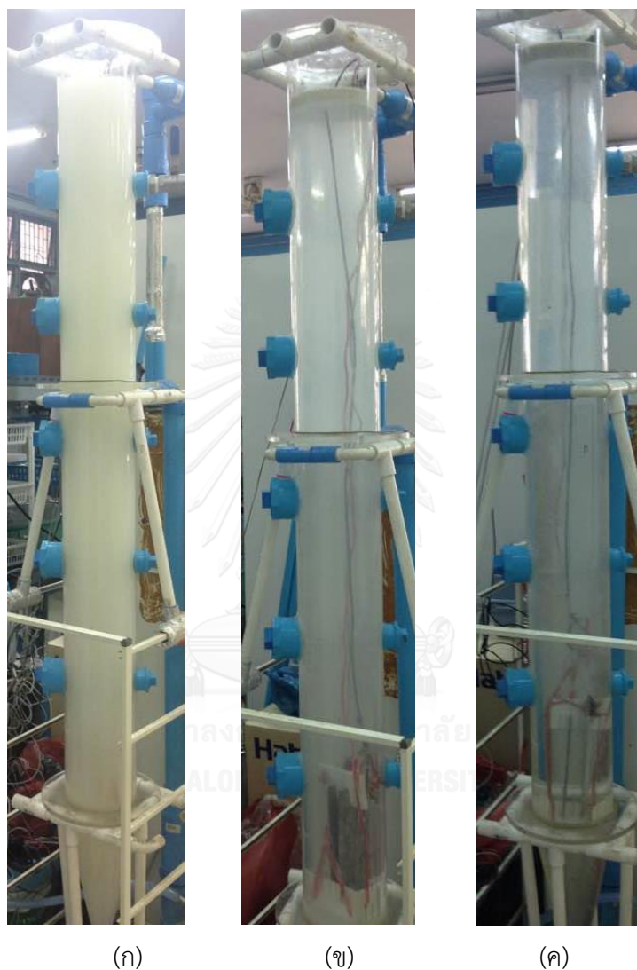
รูปที่ 4-21 การเปลี่ยนแปลงความใสของน้ำเสียสังเคราะห์ปนเปื้อนน้ำมันและชั้นตะกอนที่เกิดขึ้นในช่วงเวลาเริ่มต้นเดินระบบ (ก) ระหว่างการเดินระบบ (ข) และสิ้นสุดการเดินระบบ (ค)
