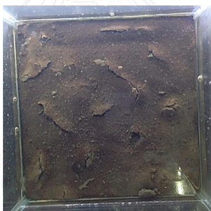
รูปที่ 4.14 รอยแตกบริเวณผิวดินที่เกิดขึ้นจากก๊าซไนโตรเจนผ่านกระบวนการดีไนทริฟิเคชันในชั้นดิน
