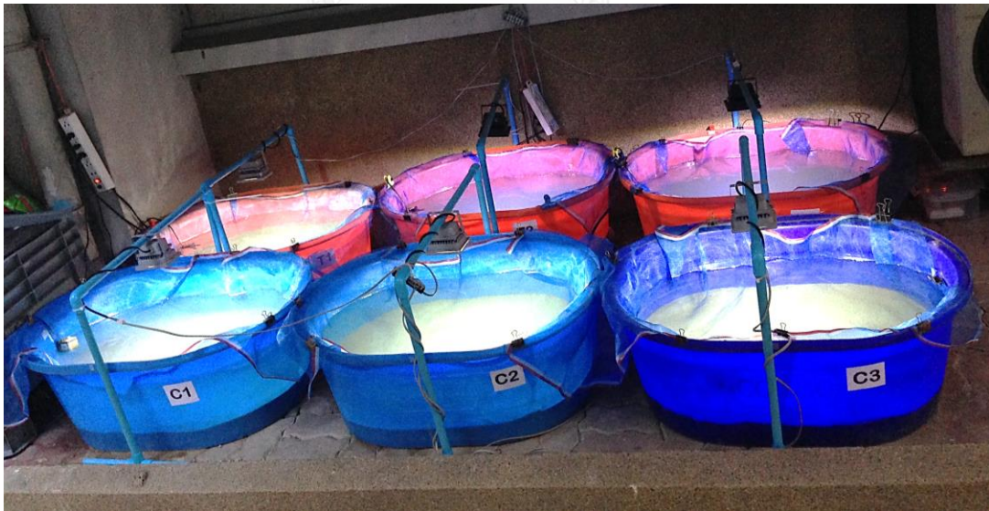
รูปที่ 3.14 ระบบการเลี้ยงสัตว์น้ำเสมือนจริงในบ่อดินจำลอง ที่มีการเปิดไฟในเวลากลางวันเพื่อให้แสงสว่างเป็นเวลา 12 ชม./วัน
