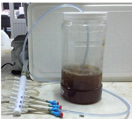
รูปที่ 3.12 การเตรียมน้ำหัวเชื้อจุลินทรีย์ตามอัตราส่วนของกรมประมง
