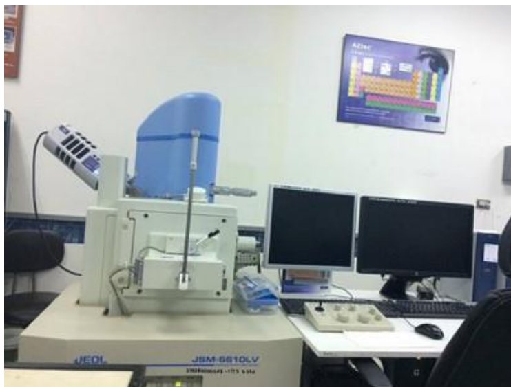
รูปที่ 3.8 SEM รุ่น JSM-6610LV ของ JEOL
