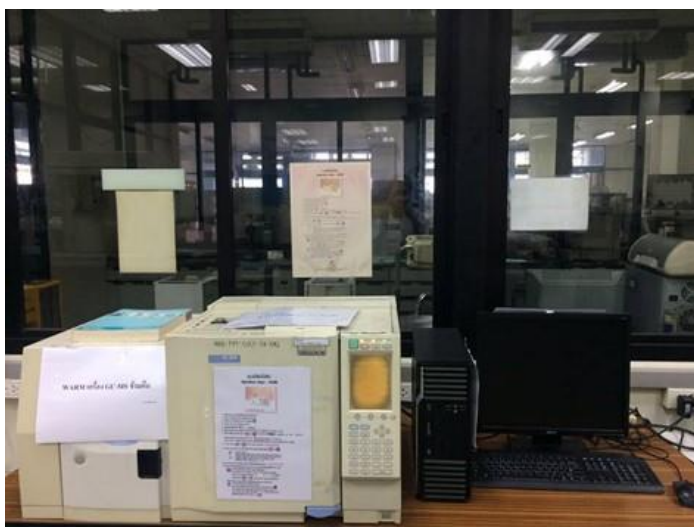
รูปที่ 3.7 GC-MS รุ่น GCMS-QP2010 ของ Shimadzu
