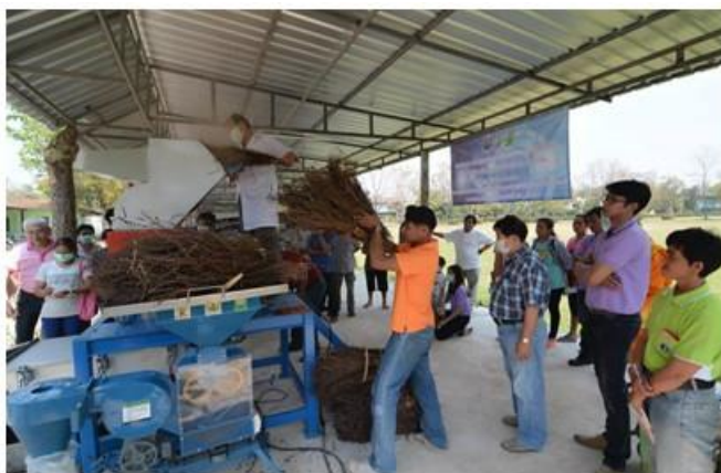
รูปที่ 2.5 เครื่องจักรที่ใช้ขนาดฝัดแมงลักแบบแห้ง
