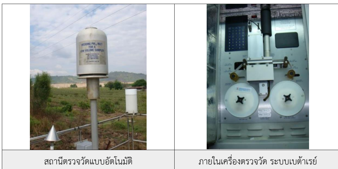
ภาพที่ 2-5 แสดงภาพเครื่องมือแบบตรวจวัดค่าอัตโนมัติระบบเบต้าเรย์ (ที่มา: คู่มือการตรวจวัดฝุ่นละอองในบรรยากาศ, 2557)
