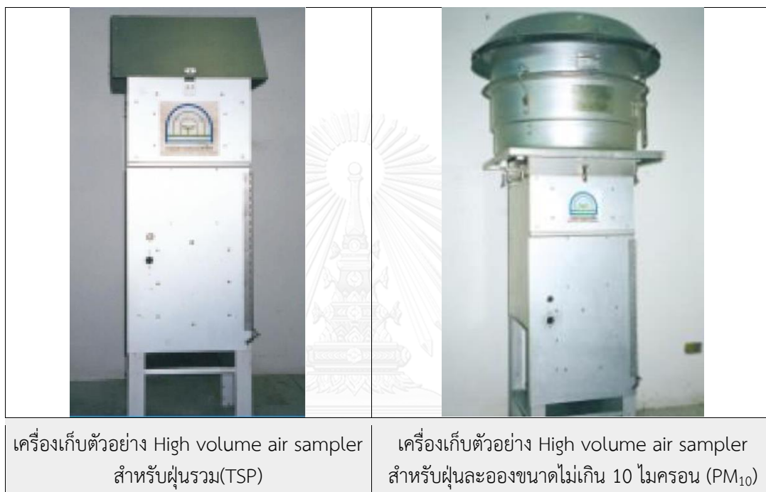
ภาพที่ 2-4 แสดงเครื่องเก็บตัวอย่าง High volume air sampler TSP และ PM 10
