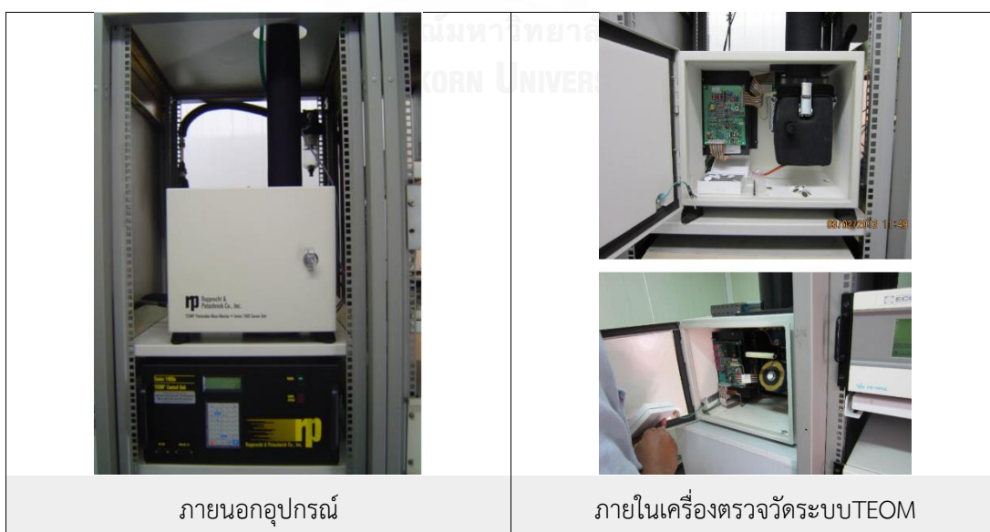
ภาพที่ 2-6 แสดงภาพเครื่องมือแบบตรวจวัดค่าระบบTEOM (ที่มา: คู่มือการตรวจวัดฝุ่นละอองในบรรยากาศ, 2557)
