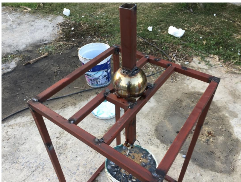
รูป 4-9 การทดลองทำจุดหมุนโดยการใช้ลูกบอลอะลูมิเนียม
