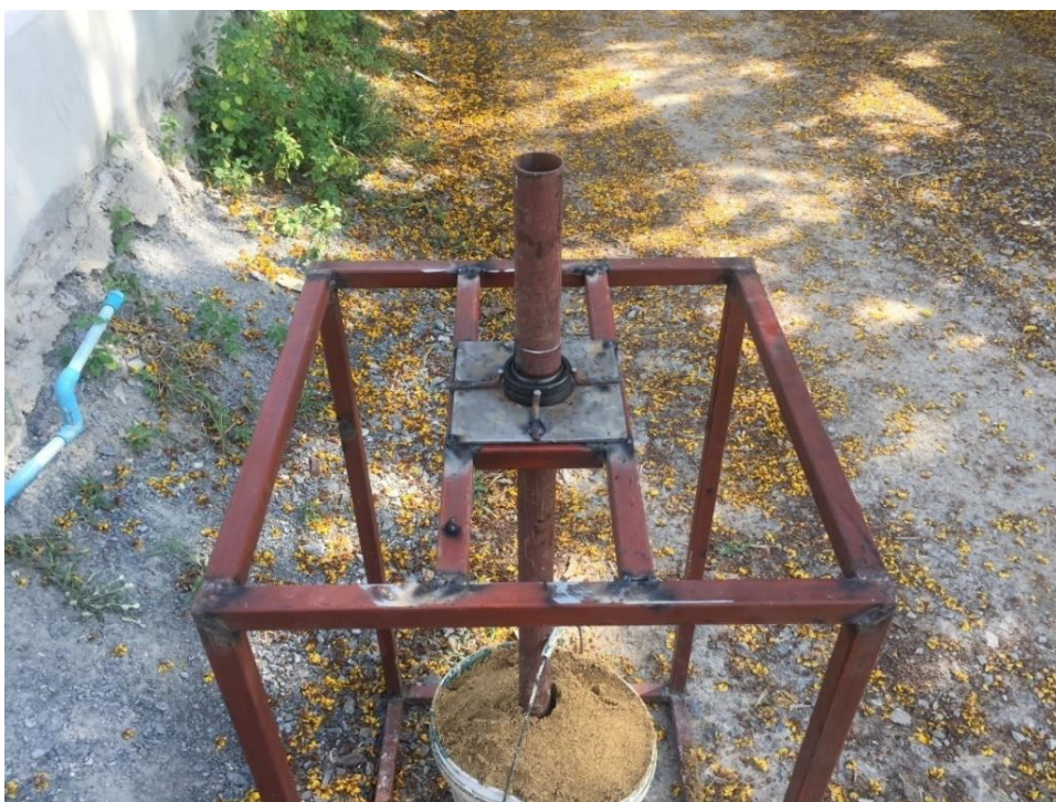
รูปที่ 4-10 การทดลองทำจุดหมุนโดยใช้ตุ้มน้ำหนักเป็นตาเหล็ก
