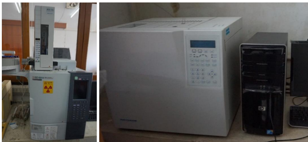
รูปที่ 3.17 เครื่องวิเคราะห์ห้องค้ประกอบของสารชนิดแก๊ส (GC-MS)
