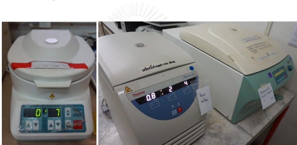
รูปที่ 3.29 เครื่องปั่นเหวี่ยงหนีศูนย์กลางใช้กับสารปริมาณน้อย (Micro Centrifuge)
