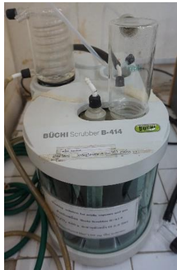
รูปที่ 3.37 เครื่องดักจับไครด (Scrubber)
