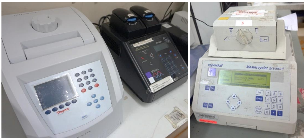
รูปที่ 3.39 เครื่องปรับเปลี่ยนอุณหภูมิของสารพันธุกรรม (Thermal Cycler)
