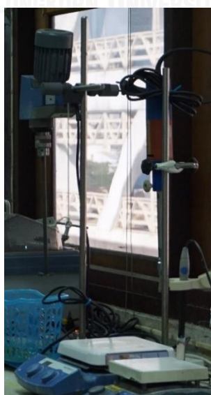
รูปที่ 3.33 เครื่องปั่นผสมสารละลาย (Overhead Stirrer)
