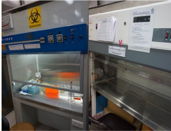
รูปที่ 3.25 ตู้ปลอดเชื้อแบบกรองอากาศ (Laminar Flow Cabinet)
