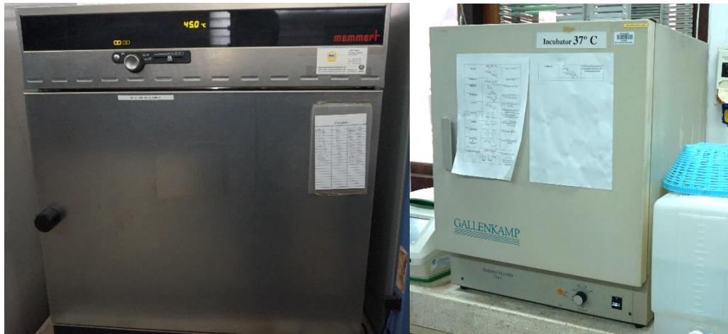
รูปที่ 3.23 ตู้บ่มเพาะเลี้ยงเซลล์หรือเนื้อเยื่อ (Incubator)
