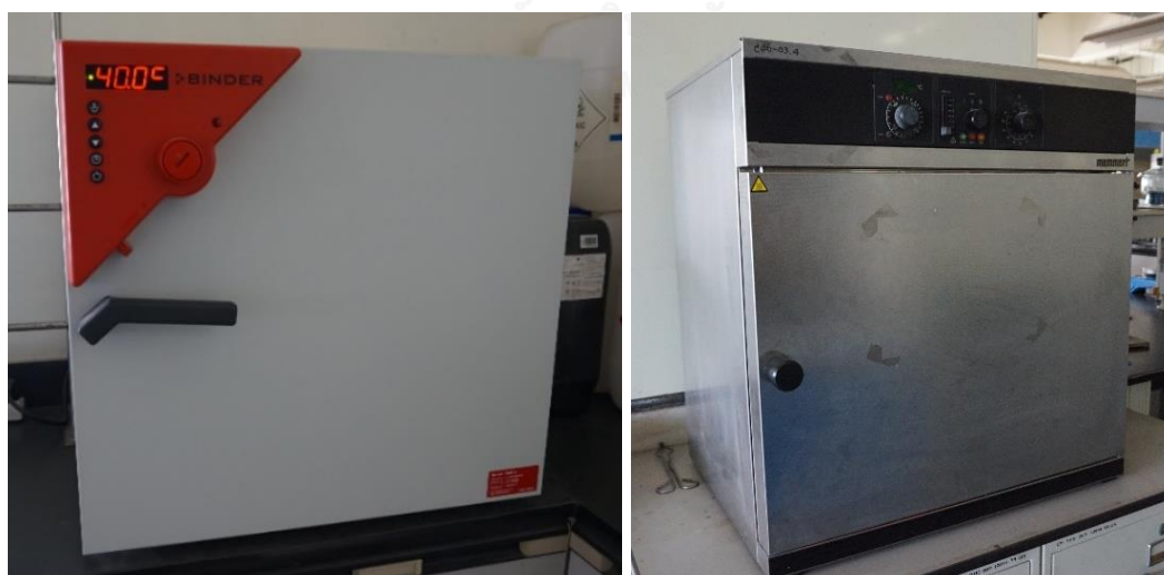
รูปที่ 3.19 ตู้อบแบบใช้ลมร้อน (Hot Air Oven)
