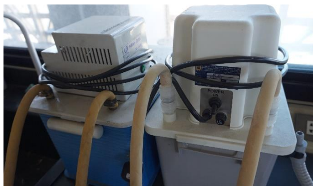
รูปที่ 3.4 เครื่องปั๊มสุญญากาศ (Aspirator)
