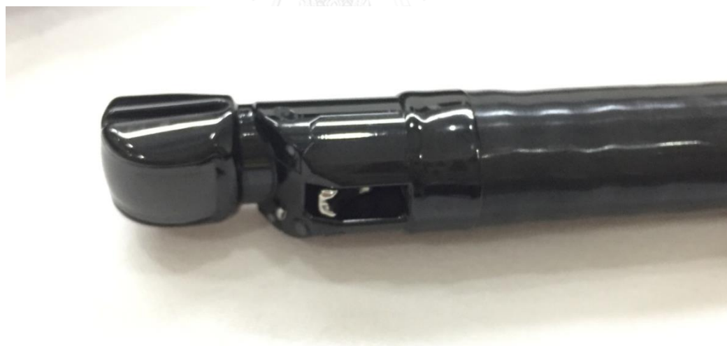
รูปที่ 10 กล้องคลื่นเสียง linear Echoendoscope : Fujifilm EG-580UT (3.8 mm. working channel)
