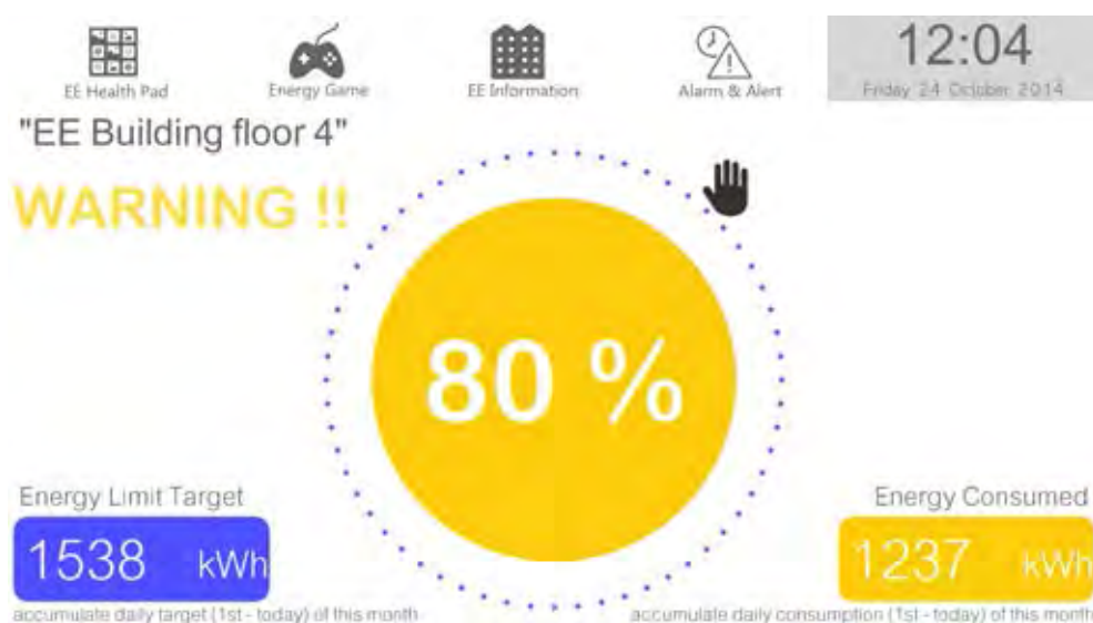
รูปที่ 4.19: หน้าจอแสดงข้อมูลการใช้พลังงานของชั้น 4 อาคารภาควิศวกรรมไฟฟ้า คิดเป็นร้อยละเมื่อเทียบกับเป้าหมาย
