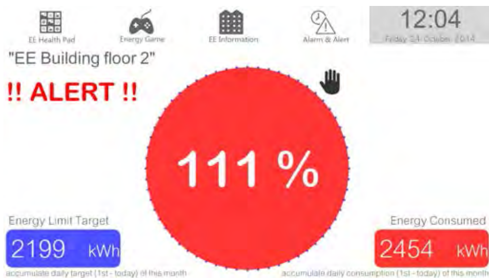
รูปที่ 4.17: หน้าจอแสดงข้อมูลการใช้พลังงานของชั้น 2 อาคารภาควิชาวิศวกรรมไฟฟ้า คิดเป็นร้อยละเมื่อเทียบกับเป้าหมาย
