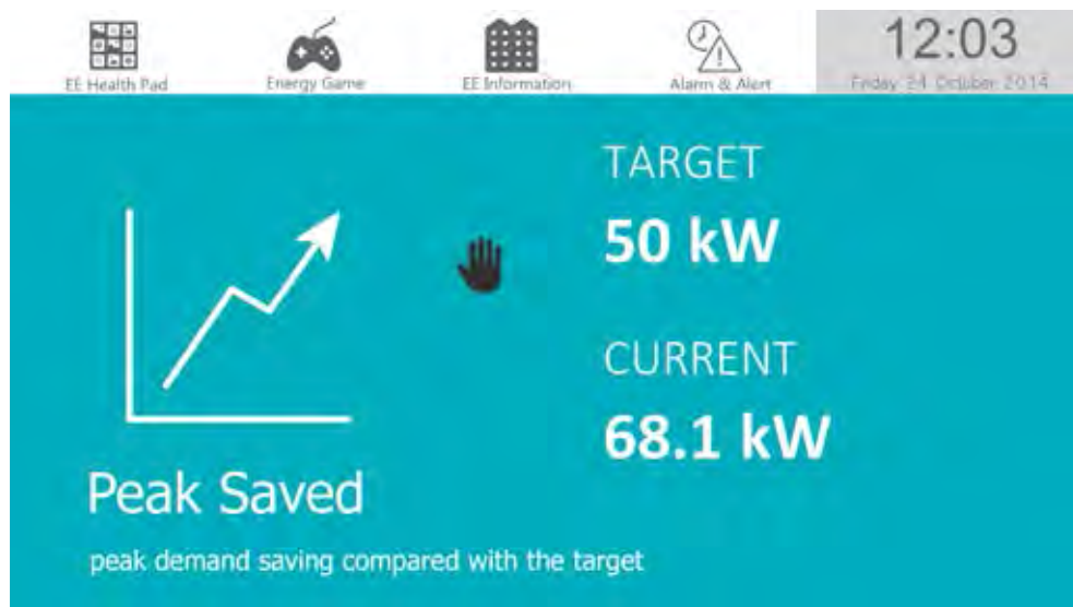
รูปที่ 4.3: หน้าจอแสดงค่าความต้องการพลังงานสูงสุดที่ลดลงได้จากเกณฑ์สูงสุดที่ตั้งไว้
