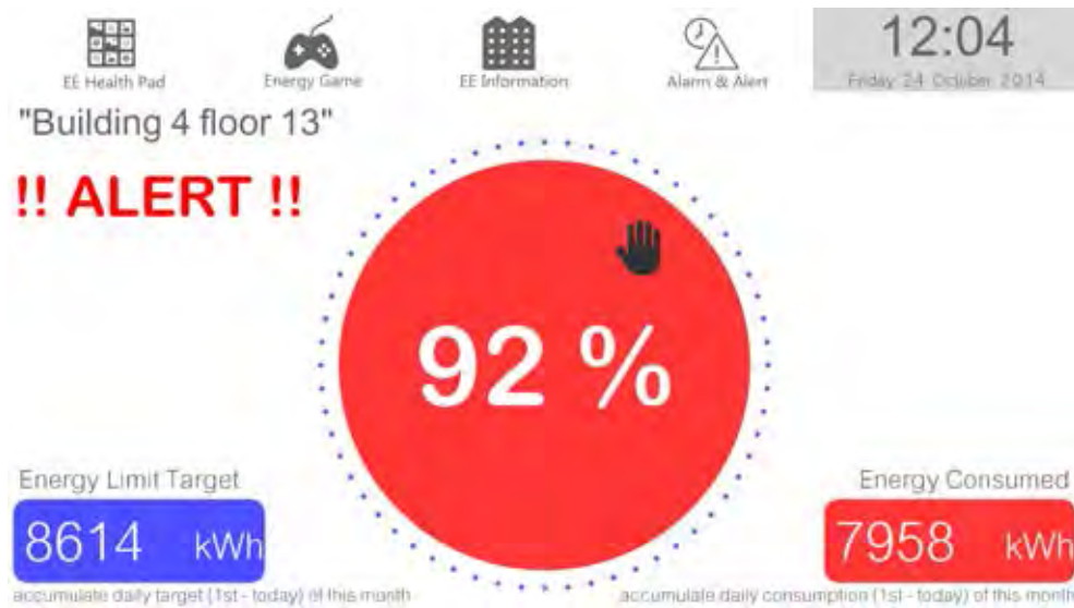
รูปที่ 4.22: หน้าจอแสดงข้อมูลการใช้พลังงานของชั้น 13 อาคารเจริญวิศวกรรม คิดเป็นร้อยละเมื่อเทียบกับเป้าหมาย
