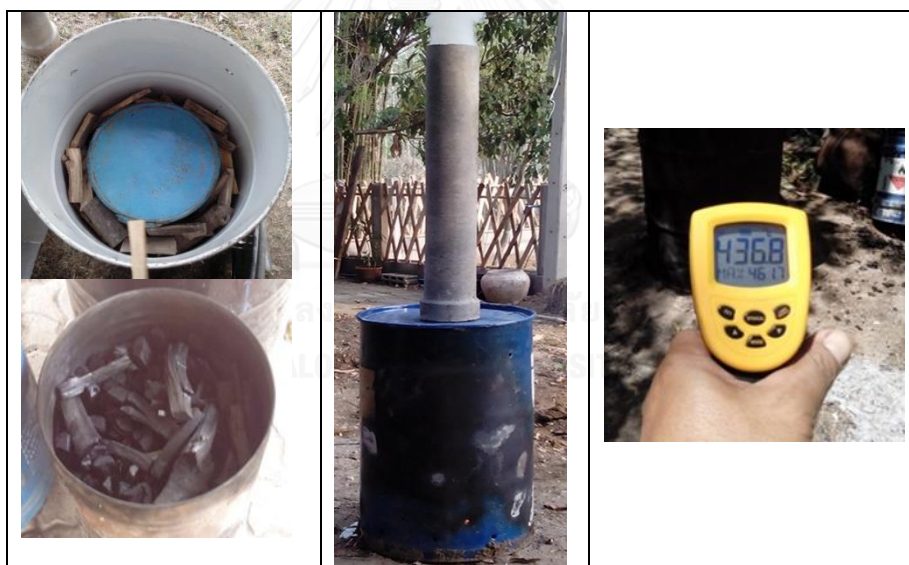
รูปที่ 24 เตาเผาถ่านชีวภาพจากถังโลหะขนาด 200 ลิตร
