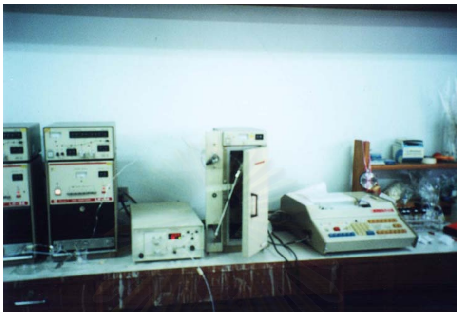
รูปที่ 3.16 High Performance Liquid Chromatography (HPLC, Shimadzu LC-3A) พร้อม Detector (LDC 4100) และ Integrator (Shimadzu CR-1A)
