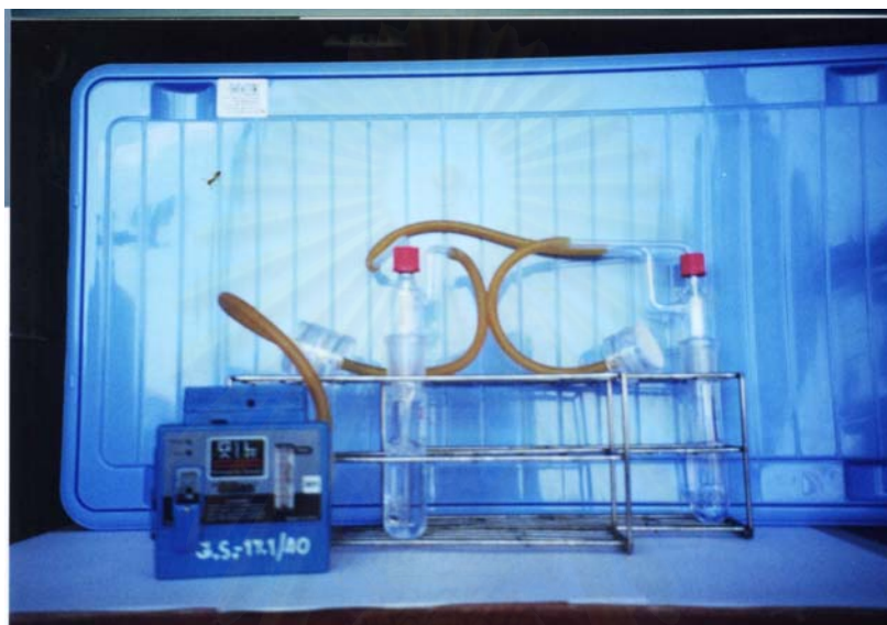
รูปที่ 3.7 ชุดเก็บตัวอย่างด้วยวิธี Active
