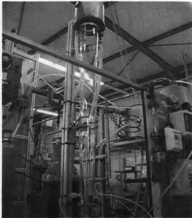
รูปที่ 3.5 ถังปฏิกริยาไฮบริดทรงกรวยที่มีขนาดเส้นผ่านศูนย์กลางเพิ่มขึ้นตามแนวแกน
