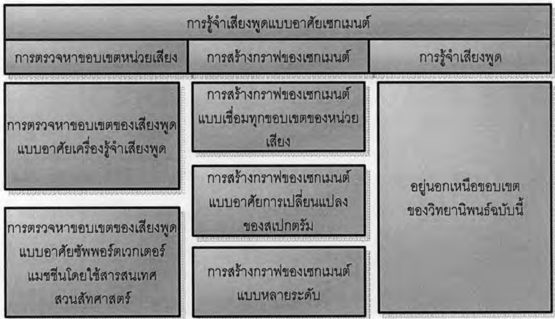
รูปที่ 4.7 แผนภาพเปรียบเทียบวิธีการที่ใช้ในแต่ละขั้นตอนของการแบ่งเสียงพูดเป็นเซกเมนต์
