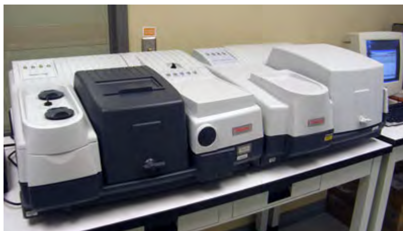
รูปที่ 3.3 เครื่อง FT-IR ของ Thermo scientific Nicolet รุ่น 6700 FT-IR
