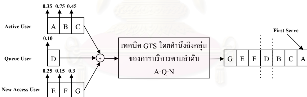
รูปที่ 6.18 ตัวอย่างการจัดสรรช่องสัญญาณแบบ GTS เมื่อมีการพิจารณากลุ่มของการบริการตามลักษณะการทำงาน
