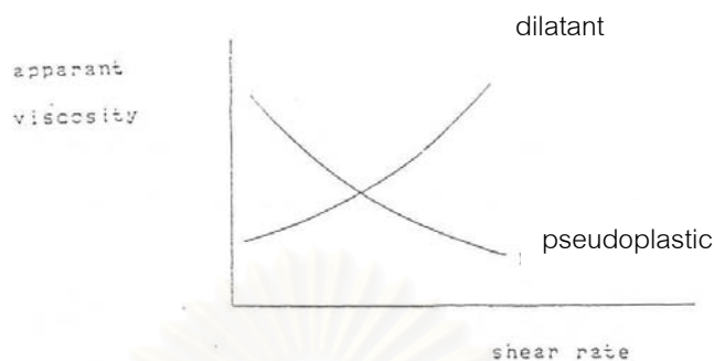
รูปที่ 2.21 ความสัมพันธ์ของ apparent viscosity กับ shear rate ของของไหลแบบต่างๆ (Schutz,1971)
