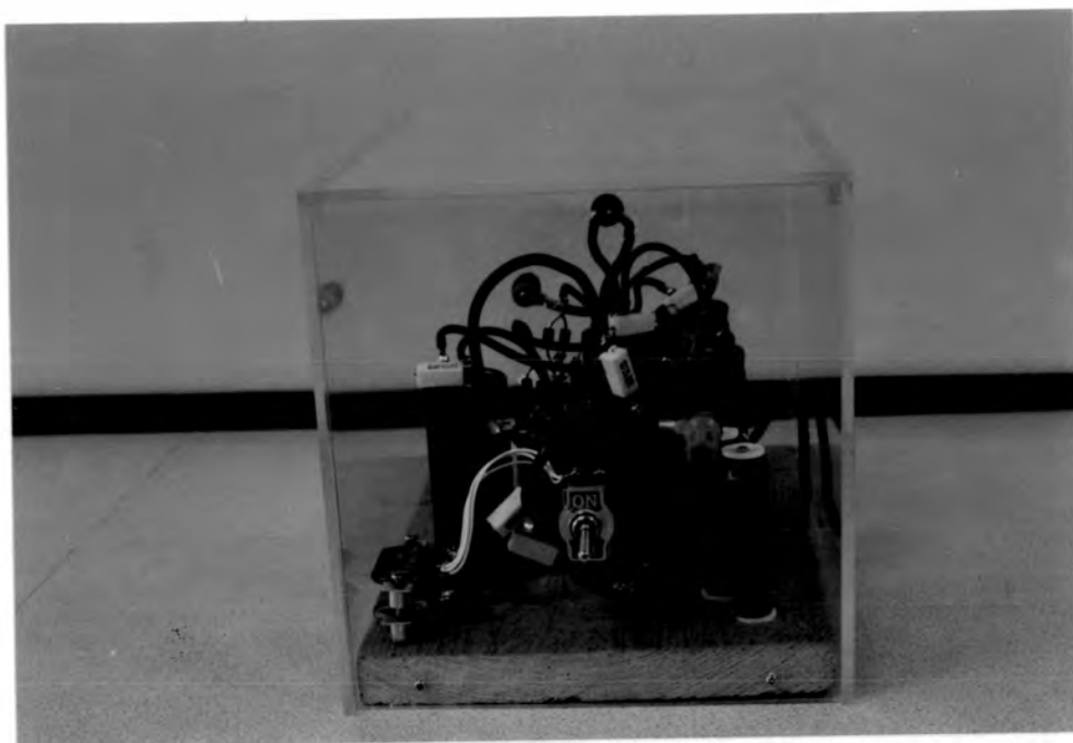
รูปที่ 3.11 เครื่องอิเล็กทรอนิกส์ ที่ให้กำเนิดคลื่นรูปพัลส์ที่ลดลงแบบเอกซ์โพเนนเชียล
