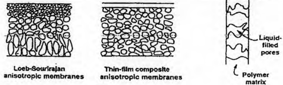
รูปที่ 2.3 การแบ่งประเภทของเมมเบรนตามโครงสร้างของเมมเบรน (Baker, 2004)
