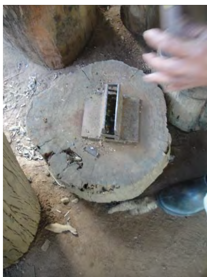
ภาพที่ ๓.๖๐ - ๓.๖๑ เครื่องมือที่ใช้เป็นหลักยึดในการตีส่วนขอบและวิธีการตีขอบมอ
