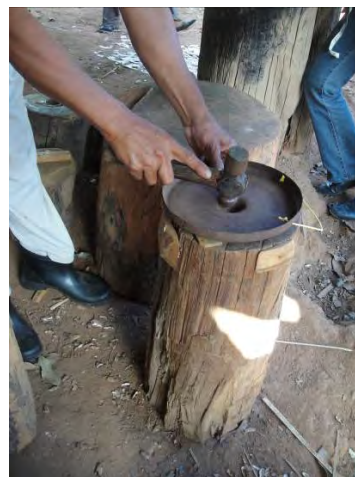
ภาพที่ ๓.๖๔ – ๓.๖๕ แบบสำหรับตีปุมตรงกลางและวิธีตีปุมตรงกลางมอง
