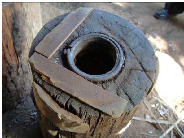
ภาพที่ ๓.๖๔ – ๓.๖๕ แบบสำหรับตีปุมตรงกลางและวิธีตีปุมตรงกลางมอง
