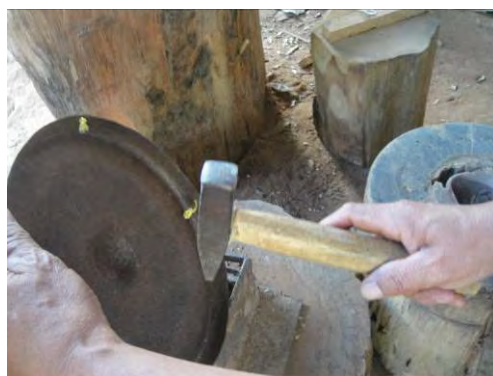
ภาพที่ ๓.๖๐ - ๓.๖๑ เครื่องมือที่ใช้เป็นหลักยึดในการตีส่วนขอบและวิธีการตีขอบมอ
