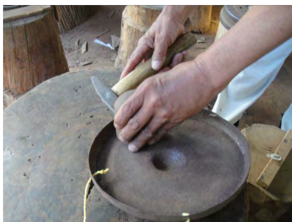
ภาพที่ ๓.๖๒ - ๓.๖๓ เครื่องมือที่ใช้ทุบภายในและวิธีการทุบภายในมอ
