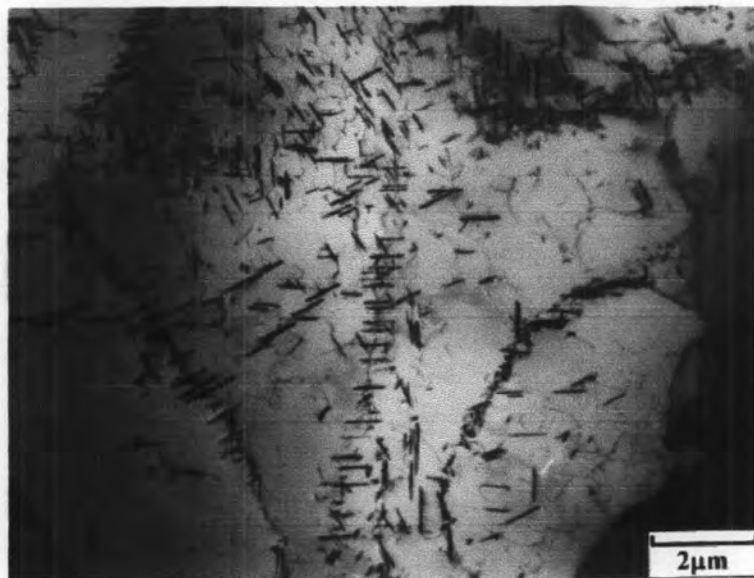
รูปที่ 2.14 การตกตะกอนโครเมียมไนไตรด์ภายในเดลตาเฟอไรต์ ถ่ายจากกล้องจุลทรรศน์อิเล็กตรอนแบบส่องผ่านแสดงโครงสร้างจุลภาคของ (700 องศา 10 นาที) [15]
