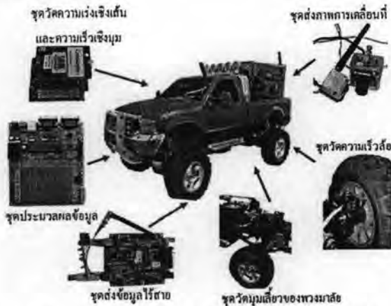
รูปที่ 10 แสดงอุปกรณ์ที่ติดตั้งบนยานพาหนะจริงแบบย่อส่วน
