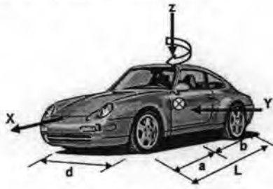
รูปที่ 1 ตำแหน่งและทิศทางตัวแปรของยานพาหนะจริงแบบย่อส่วน
