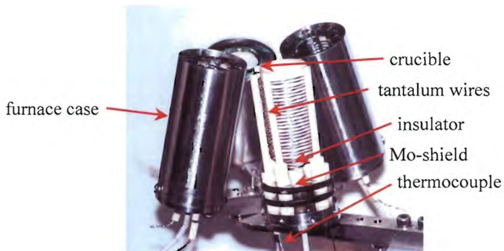
รูปที่ 3.8 ภาพถ่ายของโครงสร้างภายในแหล่งระเหยธาตุ
