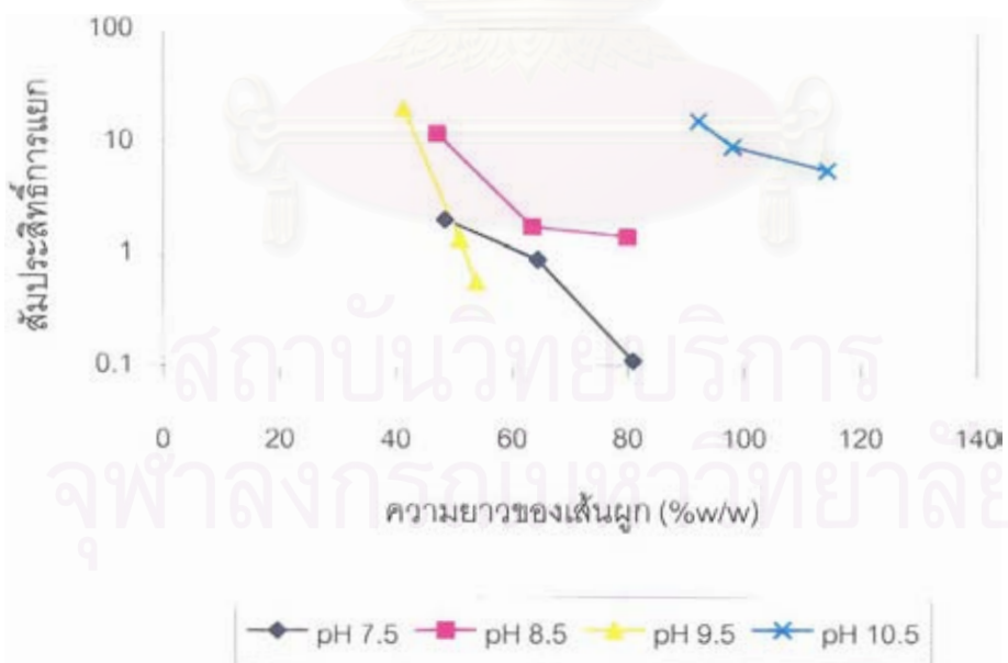
รูปที่ 5.5 ผลของความยาวของเส้นฉูกต่อค่าสัมประสิทธิ์การแยก ที่เปอร์เซ็นต์โดยน้ำหนักของโซเดียมคลอไรด์เท่ากับ 0, อุณหภูมิ 30 \pm 2 องศาเซลเซียสและที่ความดันบรรยากาศ
