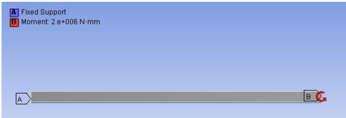
รูปที่ 4.6 กำหนดเงื่อนไขขอบเขตของคาน
