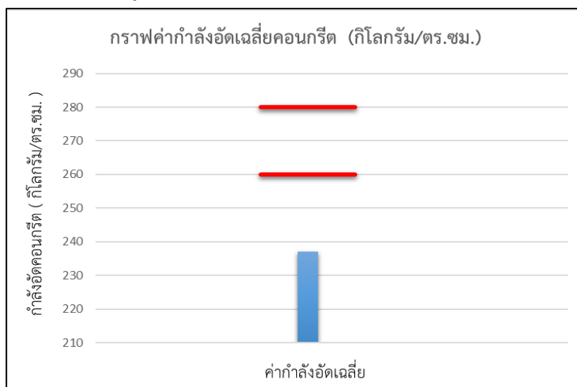
รูปที่ 1- 7 ผลทดสอบค่าเฉลี่ยกำลังอัดคอนกรีตรหัส M240
