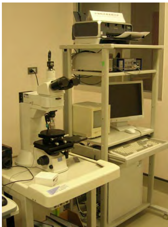
รูปที่ 4.2 แสดงรูปถ่ายกล้องจุลทรรศน์ชนิดแทรกสอดแบบอินเทอร์เน็ตโรมิเตอร์ชนิดไมเคลสัน
