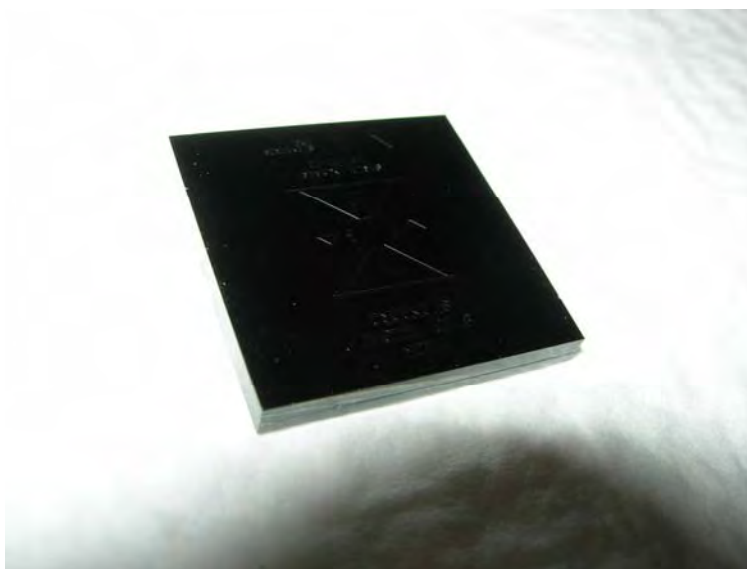
รูปที่ 3.5 แสดงชิ้นงานมาตรฐานขนาดความลึก 1.8 \mu\text{m}
