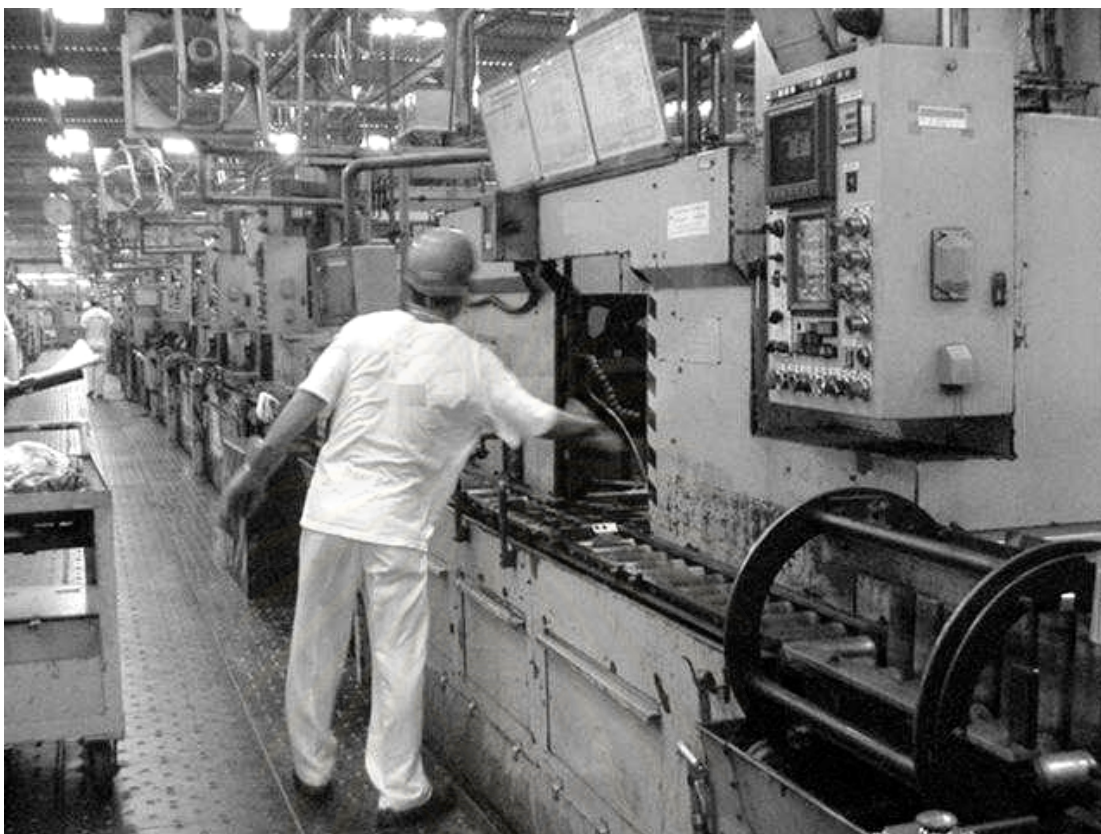
รูปที่ ๑.3 พนักงานนำชิ้นงานเข้าเครื่องจักร MC-4 ( เครื่องปาดผิวละเอียดด้านบนและ เจาะรูLocator )
