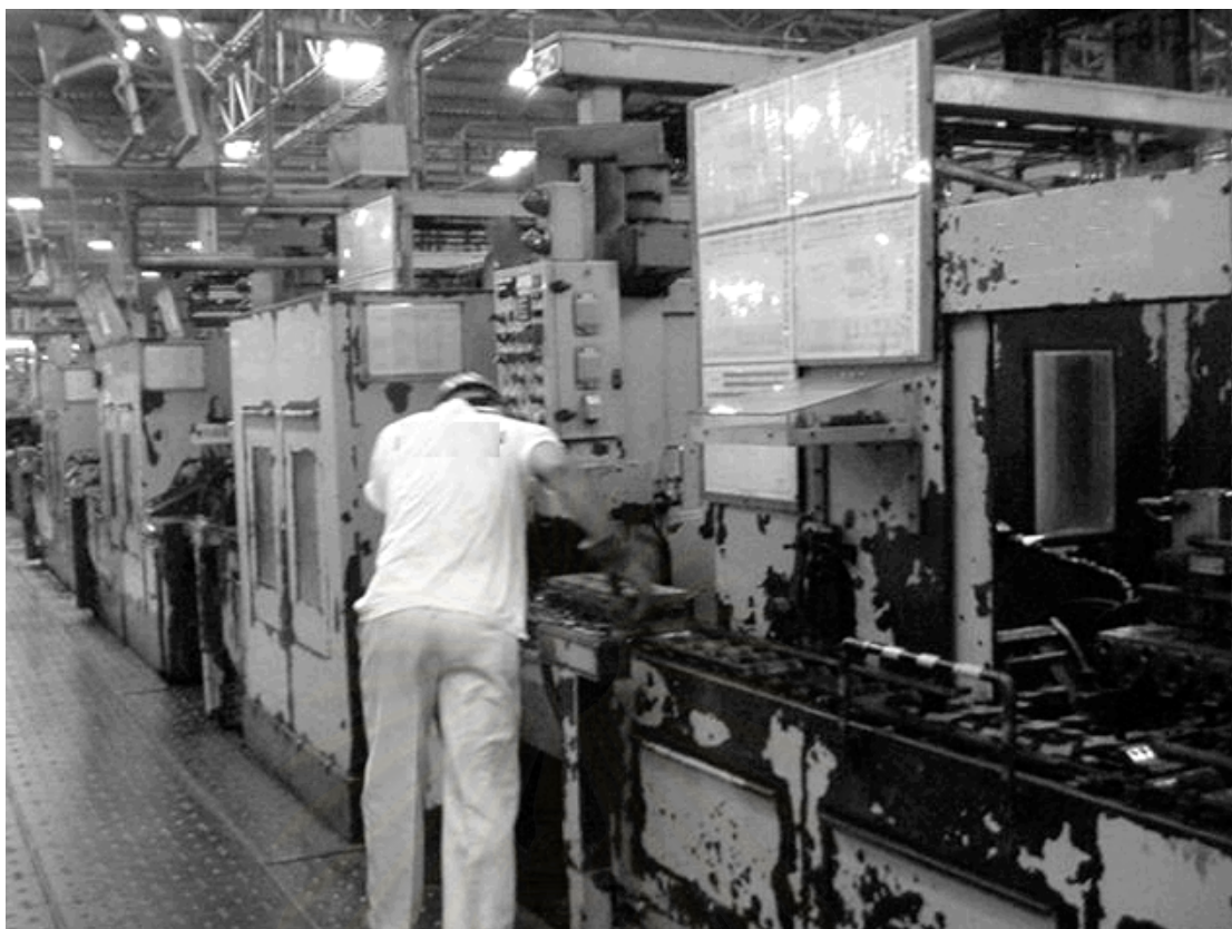
รูปที่ ๑.5 พนักงานนำชิ้นงานเข้าเครื่องจักร MC-9 ( เครื่อง เจาะรูผิวด้านหน้า,Reamingรู และทำเกลียว)
