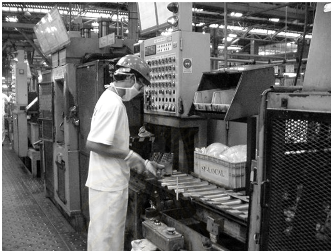
รูปที่ ๑.8 พนักงานตอก SEALING CUP ด้วยมือ(ด้านหน้าและด้านหลัง)ก่อนเข้าเครื่อง จักร MC-32 (เครื่องตอก SEALING CUP )
