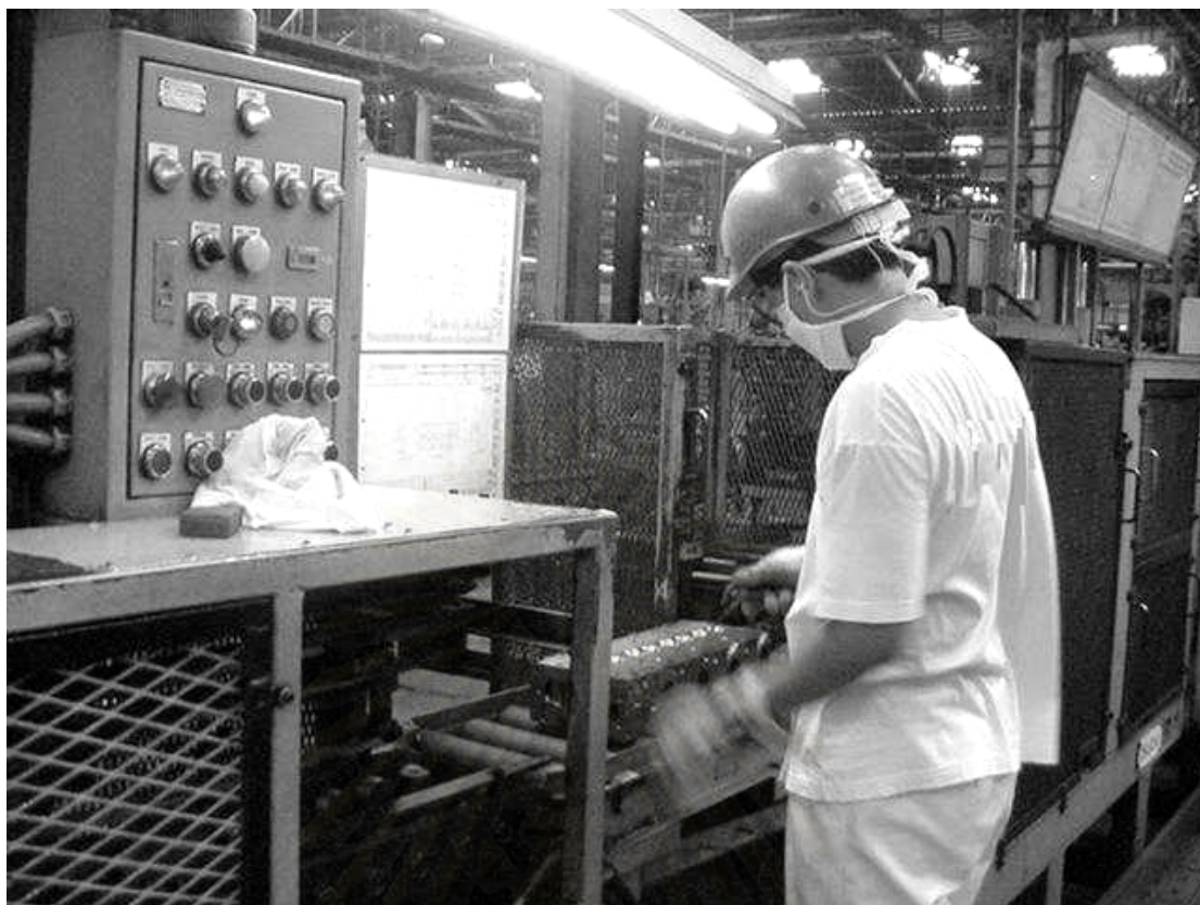
รูปที่ ๑.9 พนักงานเช็คชิ้นงานขั้นตอนสุดท้ายบริเวณ FINAL CHECK ก่อนนำชิ้นงานเข้าเครื่องจักร MC-34 ( เครื่องพ่นน้ำมันกันสนิม)
