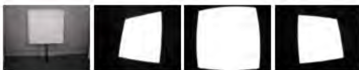
รูปที่ 1.3 แสดงภาพของกล้องวิดีโอทัศน์แต่ละตัวที่เกิดจากการบิดเบือนของเลนส์ [7]
