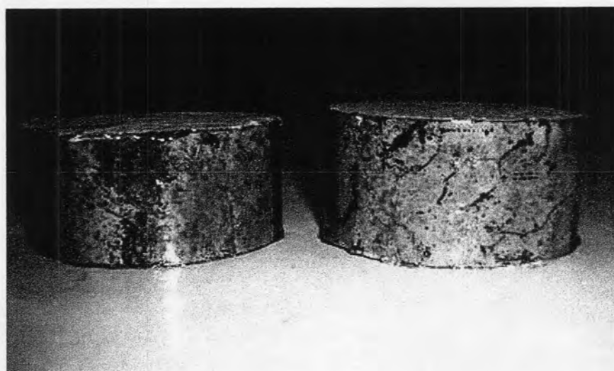
รูปที่ 3.3 ก้อนตัวอย่างที่ถูกเตรียมสำหรับการทดสอบตามมาตรฐาน ASTM C1202
