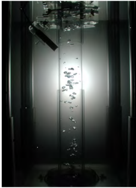
รูปที่ 2.9 รูปถ่ายแสดงลักษณะการไหลของกรณี Re_{main}=8000 Re_{sub}=0 และ J_G = 0.00219 m/s
