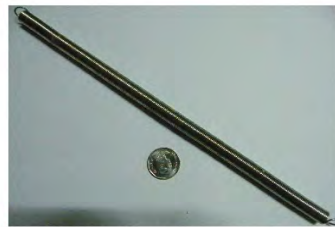
(ก) k=69 N/m (ทิศทางเดียว), ยาว 28.5 ซม., เส้นผ่านศูนย์กลาง 1 ซม.
