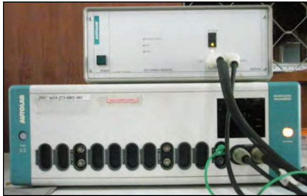
รูปที่ 3.5 เครื่อง Potentiostat/Galvanostat รุ่น PGSTA30 ของบริษัท AUTOLAB
