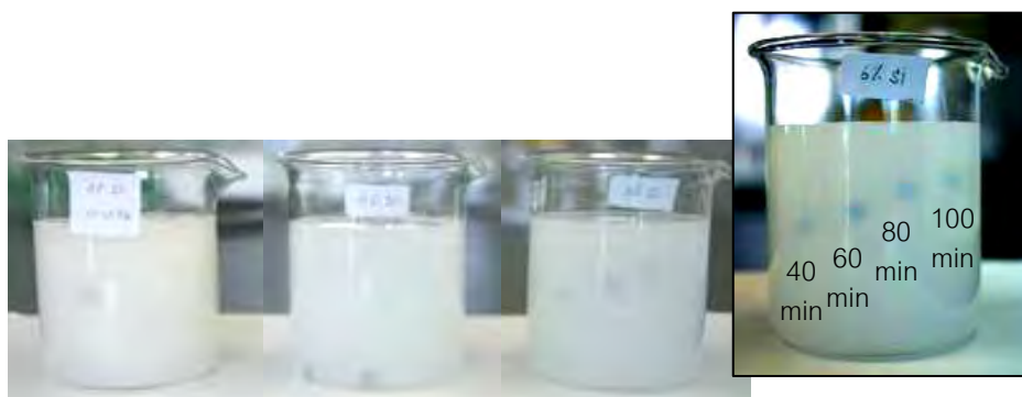
รูปที่ 3.2 ลักษณะของเจลอีเล็กโทรไลต์ในการทดสอบระยะเวลาในการเกิดเจล
