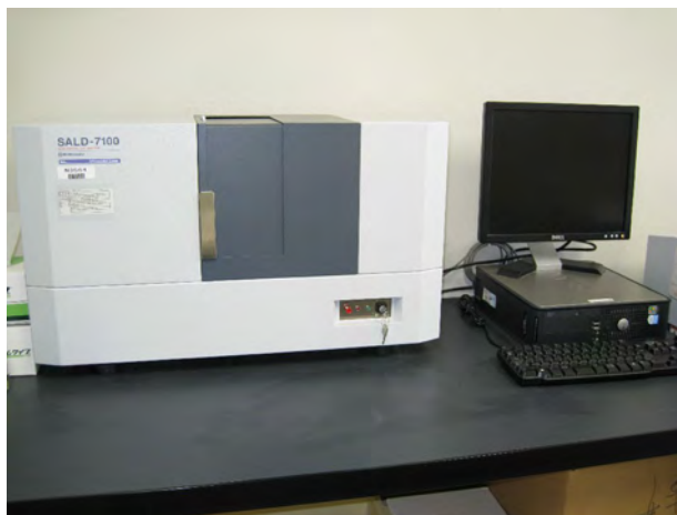
รูปที่ 3.4 เครื่อง Laser diffraction particle size analyzer (SALD-7100, Shimadzu, Kyoto, Japan)
