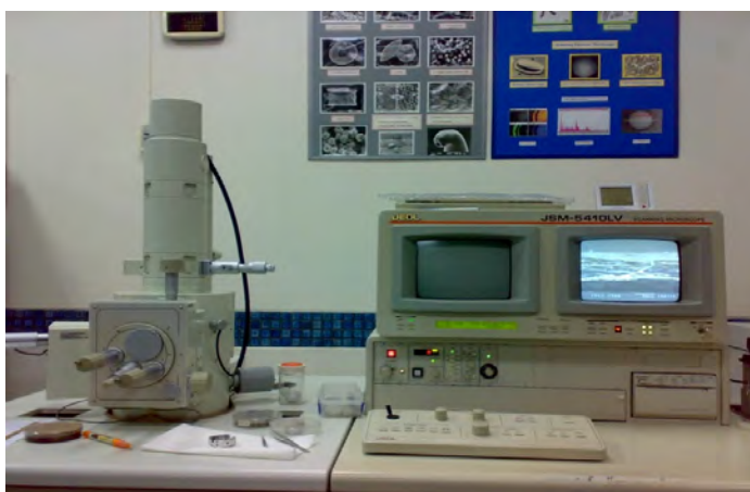
ภาพที่ 3-19 กล้องจุลทรรศน์อิเล็กตรอนแบบส่องกราด (SEM)
