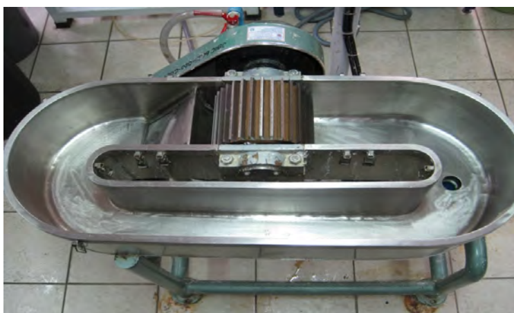
ภาพที่ 3-8 เครื่องบดเยื่อ (valley beater)
