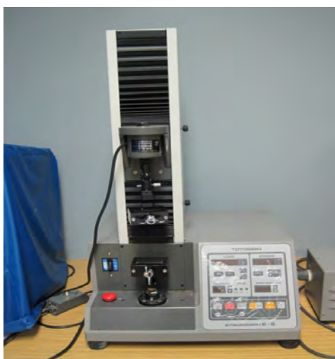
ภาพที่ 3-16 เครื่องวัดความแข็งแรงต่อแรงดึง
