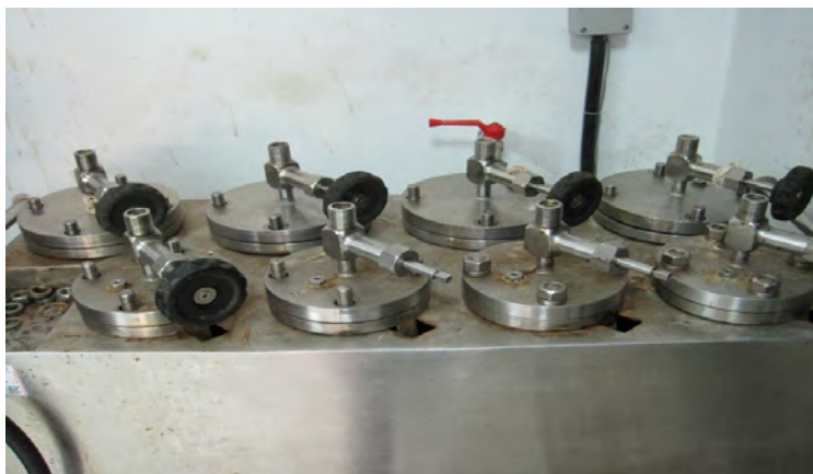
ภาพที่ 3-4 บอมบ์ (bomb) สำหรับบรรจุท่อนข้าวโพดในการต้มเยื่อ
