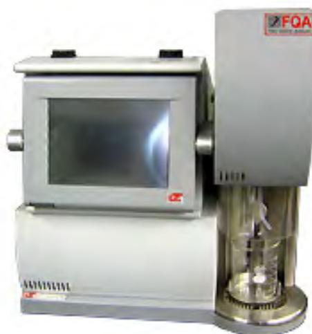
ภาพที่ 3-10 เครื่องวัดสัดส่วนฐานวิทยาของเส้นใย (FQA)
