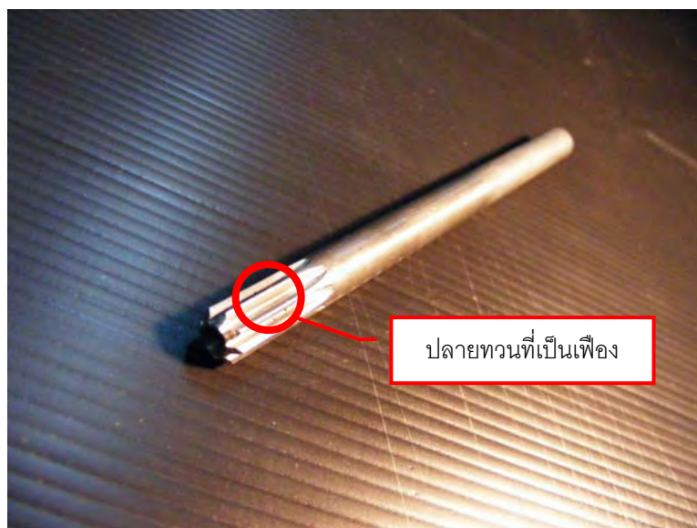
รูปที่ 5.9 ด้ามทวนที่ออกแบบไว้เพื่อใช้กับอุปกรณ์จับด้ามพลอยแบบใช้เฟืองบรรทัดที่ได้ผลิตขึ้น
