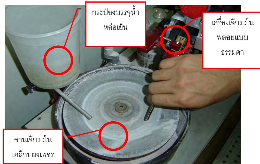
รูปที่ 3.7 การขึ้นรูปพลอยเบื้องต้น (Pre-shape) [2]
