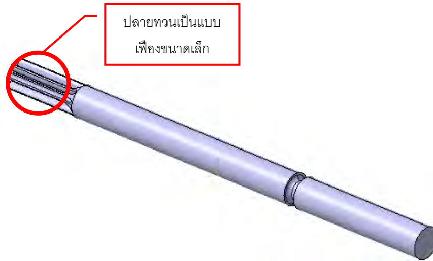
รูปที่ 5.7 ด้ามทวนที่ออกแบบไว้เพื่อใช้กับอุปกรณ์จับด้ามพลอยแบบใช้เฟืองบรรทัด
