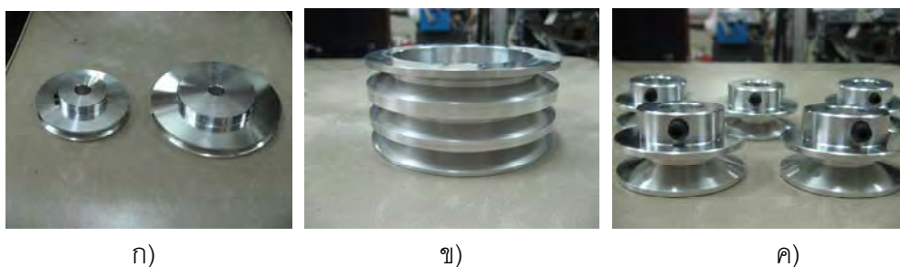
รูปที่ ก.13 ก) มู่เล่ที่ใช้ส่งกำลังจากมอเตอร์
