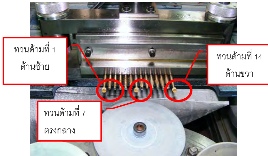
รูปที่ 7.8 การติดตั้งด้ามทวนลงบนอุปกรณ์จับด้ามพลอย
