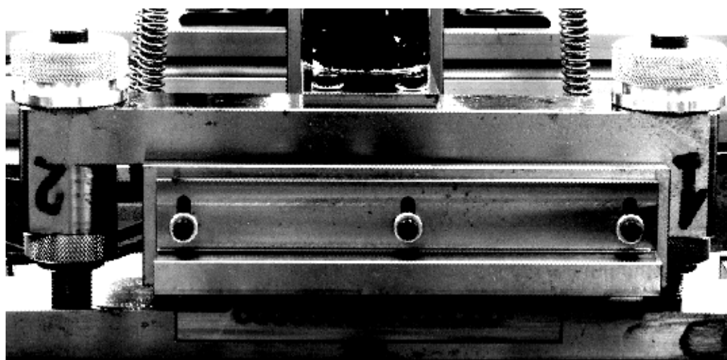
รูปที่ 5.26 การเรียงตัวของร่องลึบนบนอุปกรณ์จับด้ามพลอยแบบที่ 3
