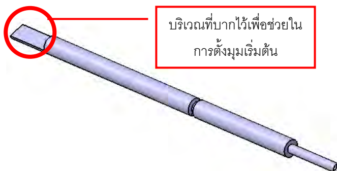
รูปที่ 5.10 ลักษณะของด้ามทวนที่ใช้กับอุปกรณ์จับด้ามพลอยแบบใช้การส่งกำลังผ่านเฟืองตรง Anti backlash
