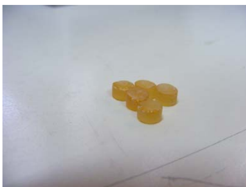
รูปที่ 7.5 ขนาดของพลอยกระบอกที่ใช้ทำการทดสอบขนาดเส้นผ่านศูนย์กลาง 5.3 มม. หนา 4.5 มม.
