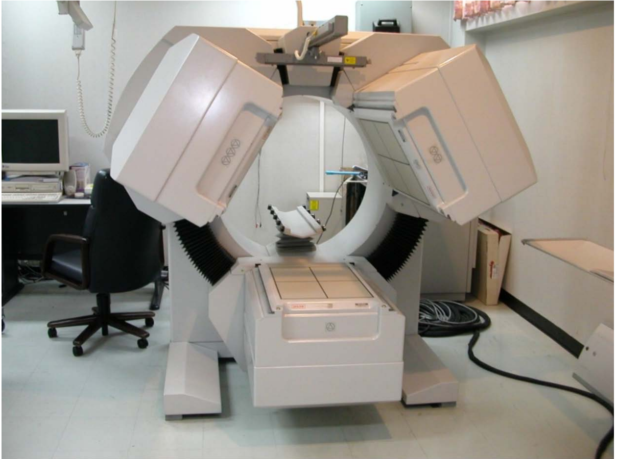
รูปภาพที่ 14. เครื่อง Single photon emission computed tomography (SPECT) แบบ 3 หัว
