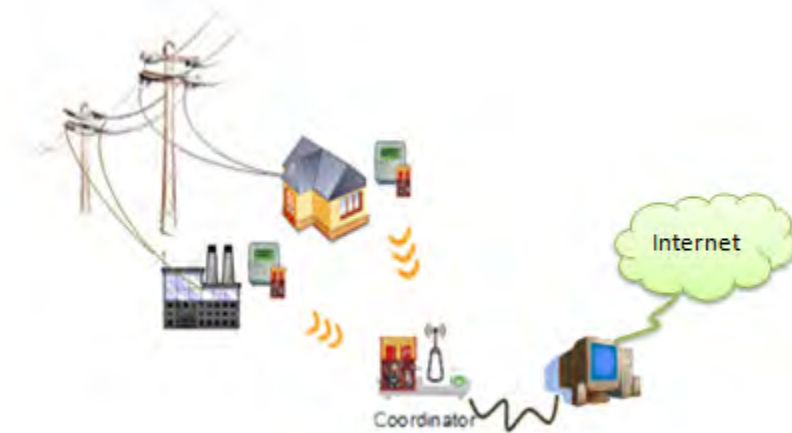
รูปที่ 3-4 ภาพรวมระบบการทำงานโดยภาพรวมของมิเตอร์อัจฉริยะแบบไร้สาย
