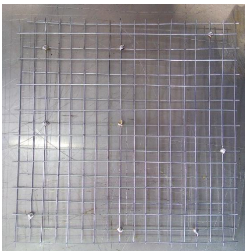
รูปที่ 3.12 ลวดตาข่ายเหล็กเชื่อมข้อติดกันด้วยกาบดกรี
