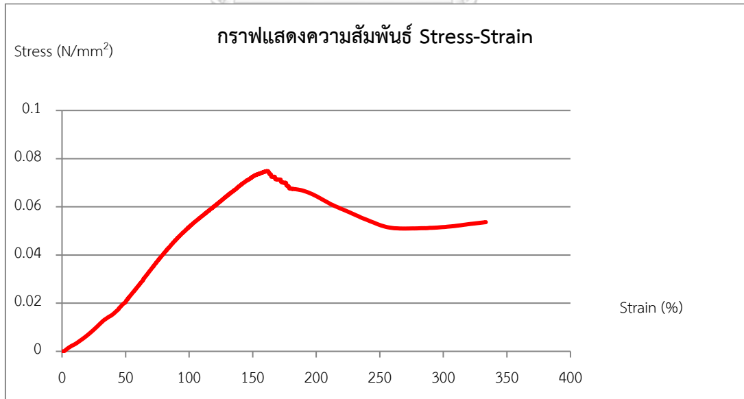
รูปที่ ค.2 แสดงความสัมพันธ์ระหว่าง Stress-Strain สำหรับชิ้นงานที่ไม่ได้เสริมลวดเหล็ก
