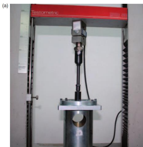
รูปที่ 2.67 a) เครื่องทดสอบการเจาะทะลุ [32]
