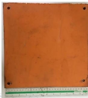
รูปที่ 3.23 ชิ้นงานทดสอบขนาด 30.5 x30.5 cm ที่ขึ้นรูปโดยการอัดขึ้นรูป
