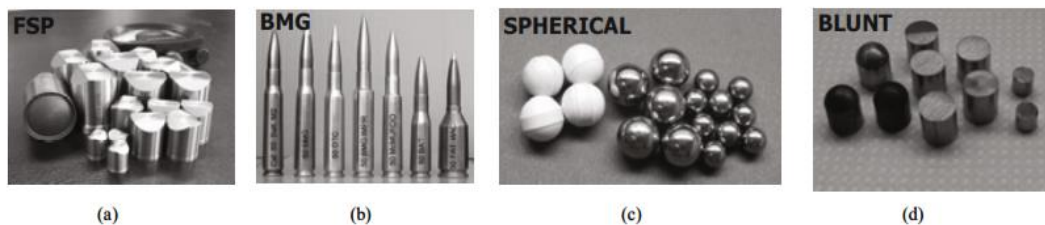
รูปที่ 2.7 ลักษณะของ Projectile โดยทั่วไปที่สามารถใช้ในการวิเคราะห์ Ballistic impact ได้ ดังนี้ a) Fragment simulating projectile b) Browning machine gun ammunition c) Spherical hard ceramic or metal ball และ และ d) blunt, hemispherical and flat head (ขนาดโดยทั่วไปตั้งแต่ 0.22-0.50 mm) [8]
