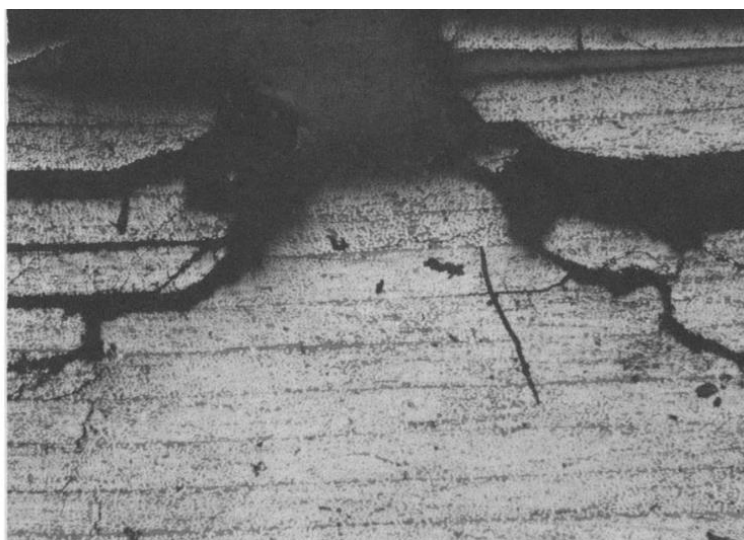
รูปที่ 2.58 วัสดุผสมที่มีจำนวนชั้น 32 ชั้น ทดสอบแบบความเร็วต่ำ โดยใช้พลังงาน 4.2J และขยายด้วยเครื่องมือโครกราฟ [13]
