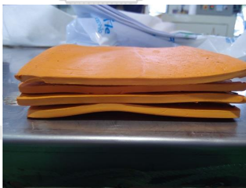
รูปที่ 3.20 ตัวอย่างชิ้นงานที่ประกบกันเรียบร้อยแล้วพร้อมใส่ลงแม่พิมพ์และเครื่องอัดตามลำดับ
