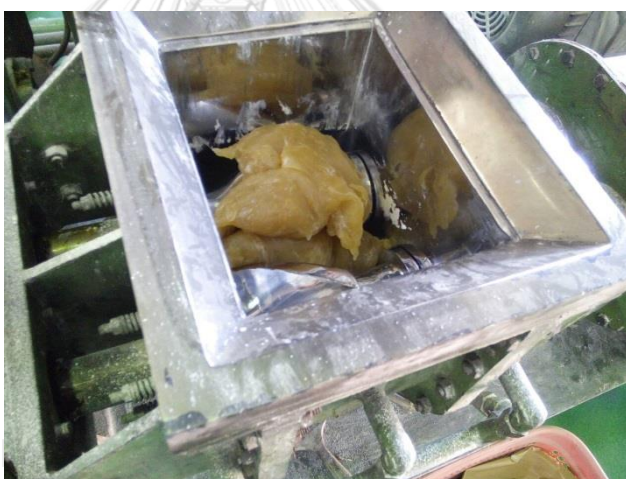
รูปที่ 3.15 ยาง STR 5L ที่เข้าเครื่องบดที่อุณหภูมิ 70°C
