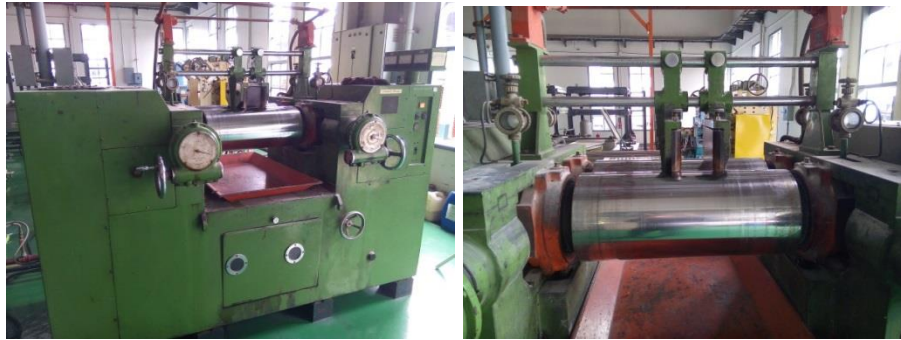
รูปที่ 3.17 เครื่องบดยางพาราให้ได้ขนาดความหนาตาที่ต้องการ
