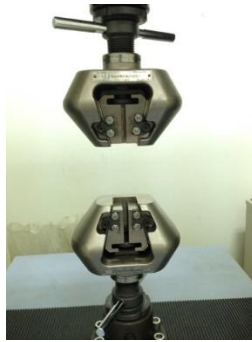
รูปที่ 3.4 หัวทดสอบแรงดึงชิ้นงาน
