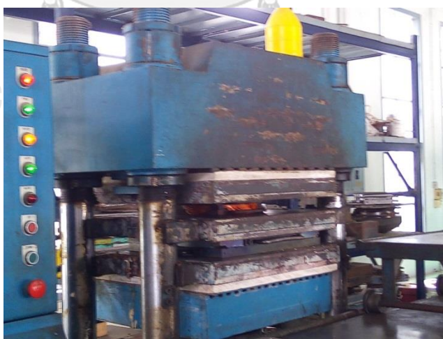
รูปที่ 3.22 แสดงขณะกำลังอัดชิ้นรูปชิ้นงานตามแม่พิมพ์
