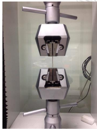
(ก) เครื่องมือทดสอบความทนแรงดิ่ง
