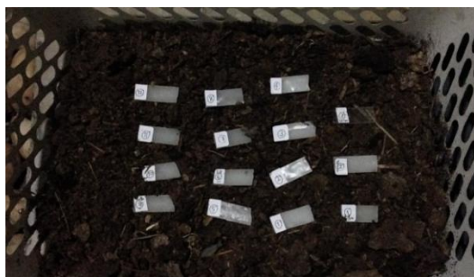
รูปที่ 4.88 ชิ้นงานพอลิเมอร์ผสม PLA/PP ทั้งที่ไม่มีและที่มีสารเพิ่มความเข้ากันได้เตรียมนำฝังดิน
