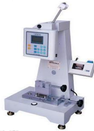
(ข) เครื่องมือทดสอบความทนแรงกระแทก
