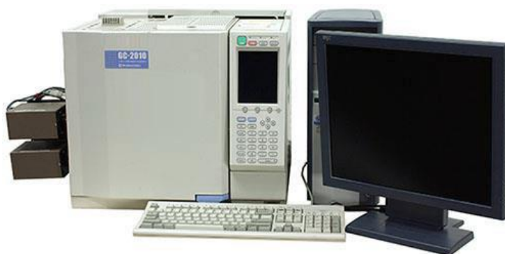
รูปที่ 3.4 เครื่องแก๊สโครมาโทกราฟี – แมสสเปกโตรมิเตอร์ Shimadzu รุ่น GC – 2010
