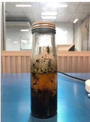
รูปที่ 4.9 ผลิตภัณฑ์น้ำมันชีวภาพจากกระบวนการไพโรไลซิสแบบต่อเนื่องของเหง้ามันสำปะหลัง
