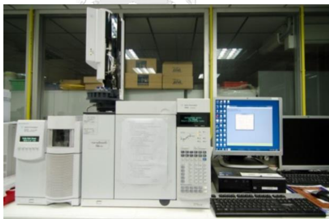
รูปที่ 3.8 เครื่องแก๊สโครมาโทกราฟี-แมสสเปกโตรมิเตอร์
