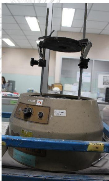
รูปที่ 3.1 เครื่องคัดขนาด Endecott SHAKER EFL1 mk3
