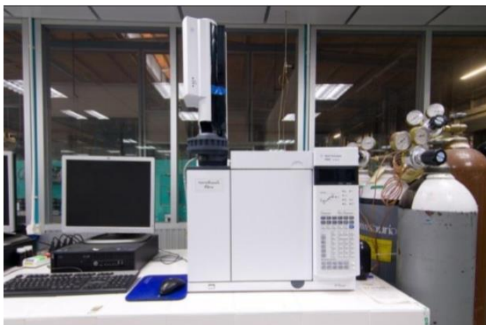
รูปที่ 3.7 เครื่องแก๊สโครมาโทกราฟีพร้อมซอฟต์แวร์จำลองการกลั่น
