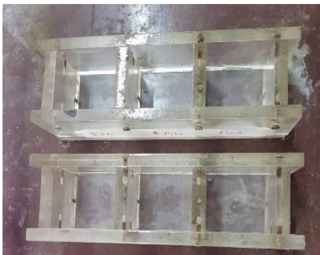
ภาพที่ ข- 4 แบบหล่อทรงลูกบาศก์ขนาด 5 เซนติเมตร
