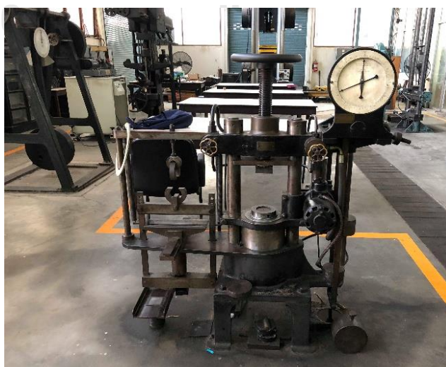
ภาพที่ ข- 6 เครื่องทดสอบค่ากำลังรับแรงอัด น้ำหนักกดสูงสุด 30 ตัน (Amsler 30 ton)
