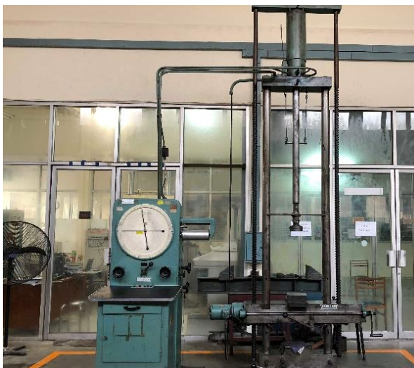
ภาพที่ ข- 7 เครื่องทดสอบค่ากำลังรับแรงอัด
