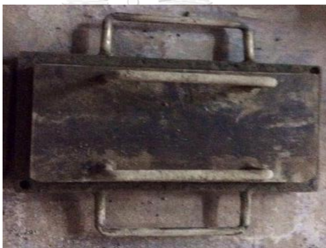
ภาพที่ ข- 5 แบบหล่อทรงสี่เหลี่ยมผืนผ้า ขนาด 13 x 26 x 2 เซนติเมตร
