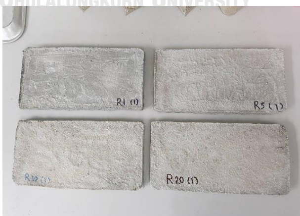
ภาพที่ ข- 9 ตัวอย่างมอร์ตาร์ทรงสี่เหลี่ยมผืนผ้า ขนาด 13x26x2 เซนติเมตร
