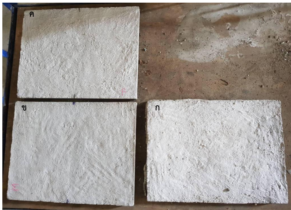
ภาพที่ 4- 17 กระเบื้องหลังคาซีเมนต์ (ก) ที่แทนที่ด้วยเส้นใยหรือควูล (ข) ที่แทนที่ด้วยตะกอนจากโรงผลิตน้ำประปา (ค) ที่แทนที่ด้วยผงที่บดจากแผงวงจรอิเล็กทรอนิกส์ส่วนที่ไม่ใช่โลหะ
