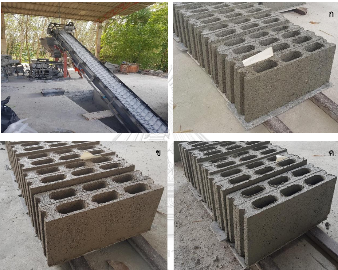
ภาพที่ 4- 18 อิฐบล็อกปูผนังชนิดไม่รับน้ำหนัก (ก) ที่แทนที่ด้วยเส้นใยรีโอคิวล (ข) ที่แทนที่ด้วย ตะกอนจากโรงผลิตน้ำประปา (ค) ที่แทนที่ด้วยผงที่บดจากแผงวงจรอิเล็กทรอนิกส์ส่วนที่ไม่ใช่โลหะ
