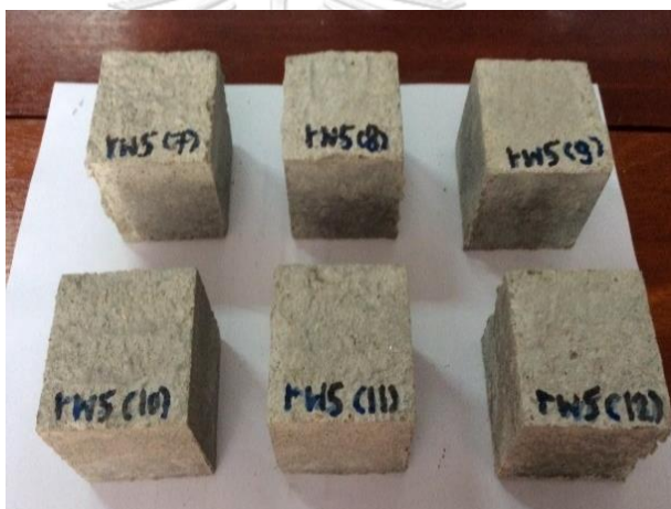
ภาพที่ ข- 8 ตัวอย่างมอร์ตาร์ทรงลูกบาศก์ขนาด 5 เซนติเมตร
