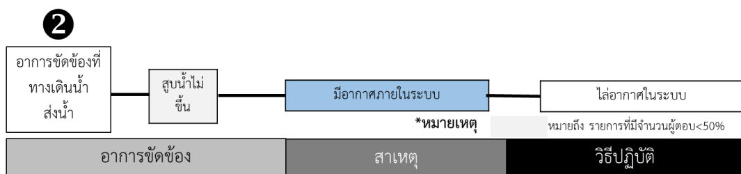
รูปที่ 5. 52 แผนผังเชื่อมโยงอาการขัดข้อง สาเหตุของอาการขัดข้อง และวิธีปฏิบัติเมื่อเกิดอาการขัดข้องที่ทางเดินน้ำส่งน้ำของอุปกรณ์ Chiller Water Pump
