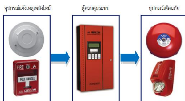
รูปที่ 2. 39 อุปกรณ์หลักของระบบสัญญาณแจ้งเหตุเพลิงไหม้(กรมโรงงานอุตสาหกรรม, 2552)
