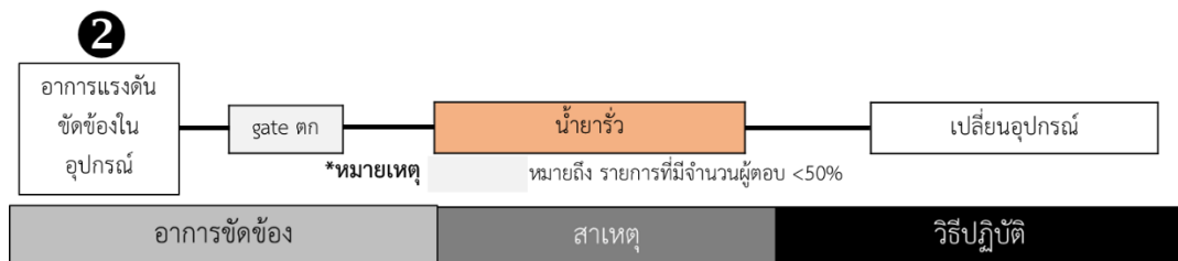
รูปที่ 5. 89 แผนผังเชื่อมโยงอาการขัดข้อง สาเหตุของอาการขัดข้อง และวิธีปฏิบัติเมื่อเกิดอาการแรงดันขัดข้องในอุปกรณ์ของอุปกรณ์ Fire Hydrant
