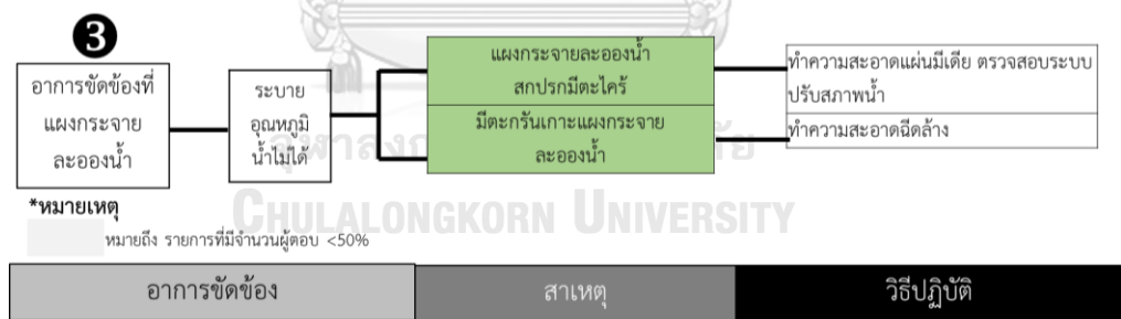
รูปที่ 5. 41 แผนผังเชื่อมโยงอาการขัดข้อง สาเหตุของอาการขัดข้อง และวิธีปฏิบัติเมื่อเกิดอาการขัดข้องที่ตัวถังและเกล็ดช่องลมของอุปกรณ์ Cooling Tower
