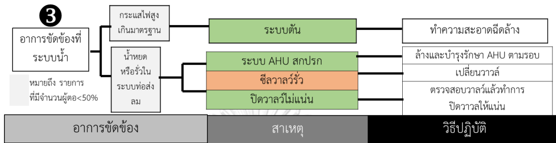
รูปที่ 5. 46 แผนผังเชื่อมโยงอาการขัดข้อง สาเหตุของอาการขัดข้อง และวิธีปฏิบัติเมื่อเกิดอาการขัดข้องที่อุปกรณ์กรองอากาศของอุปกรณ์ Air Handling Unit
