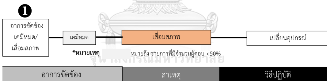
รูปที่ 5. 88 แผนผังเชื่อมโยงอาการขัดข้อง สาเหตุของอาการขัดข้อง และวิธีปฏิบัติเมื่อเกิดอาการขัดข้องอาการขัดข้องเคมีหมด/เสื่อมสภาพ ของอุปกรณ์ Fire Hydrant
