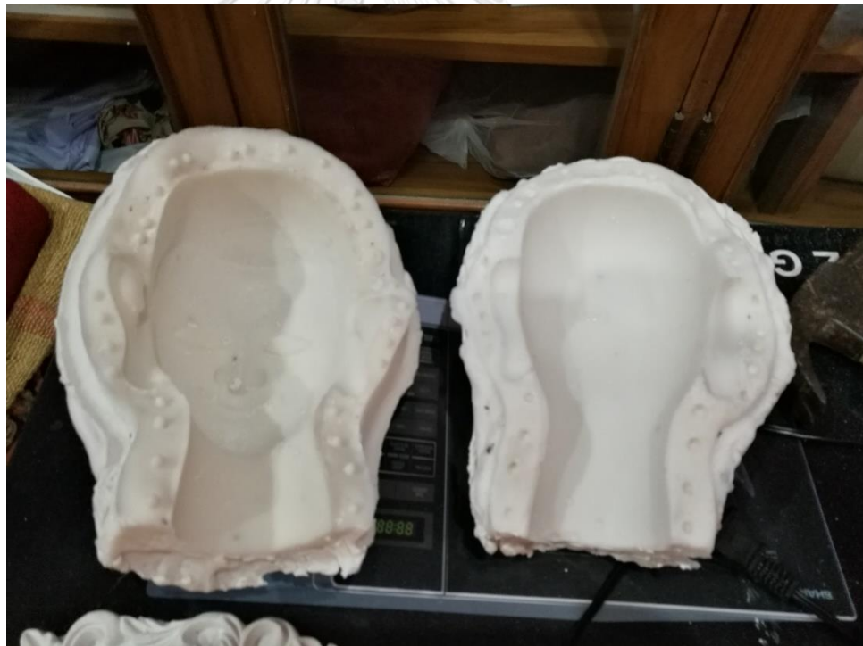
ภาพที่ 47 ภาพแม่พิมพ์หัวหุ่นแบบประกบที่สำเร็จแล้วสำหรับการหล่อแบบ โดยผู้วิจัย
