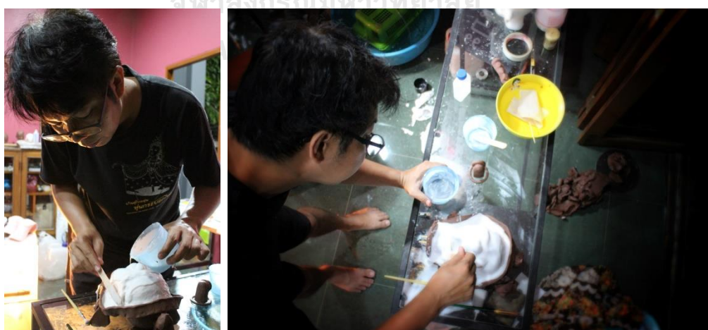
ภาพที่ 45 ภาพถ่ายขั้นตอนการหล่อยางซิลิโคนบนหัวหุ่นต้นฉบับ
