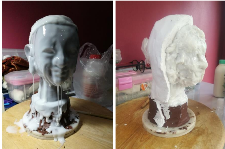
ภาพที่ 46 ภาพการทำแม่พิมพ์ซิลิโคนและแม่พิมพ์บังคับสำหรับการหล่อแบบเรซิน โดยผู้วิจัย
