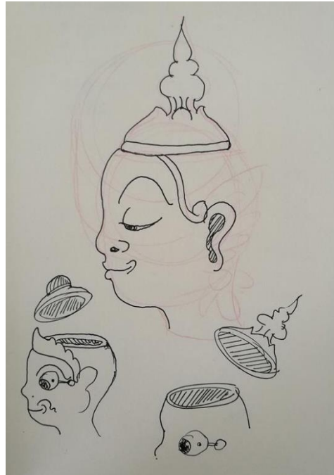
ภาพที่ 39 ภาพร่างกลไกการเปิดกะโหลกหัวหุ่น เพื่อถ่ายทอดการประกอบและการซ่อมแซม โดยผู้วิจัย
