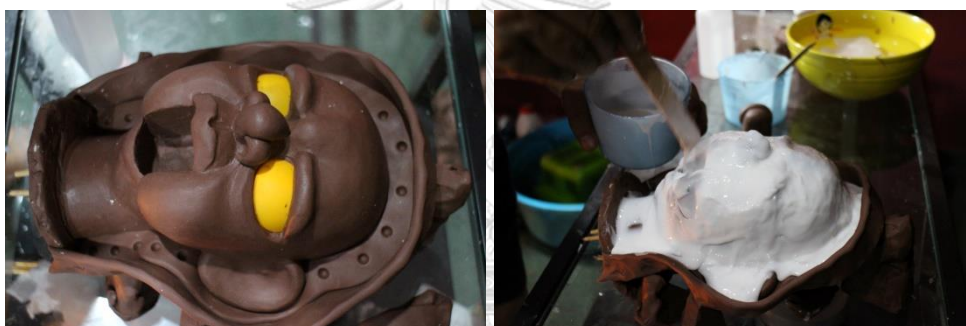
ภาพที่ 44 ภาพถ่ายขั้นตอนการสร้างแม่พิมพ์ประกบหน้าหลัง (ซ้าย) การหล่อยางซิลิโคน (ขวา)
