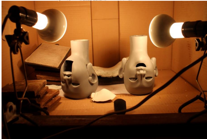
ภาพที่ 50 ภาพถ่ายขั้นตอนการอบสีรองพื้นหุ่นก่อนทำแม่พิมพ์ โดยใช้ไฟส่องสว่าง
