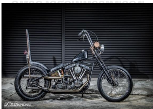
ภาพที่ 17 มอเตอร์ไซค์ซ้อปเปอร์ในทรงโอสคูลที่ใช้เครื่องยนต์ Harley-davidson Shovelhead
