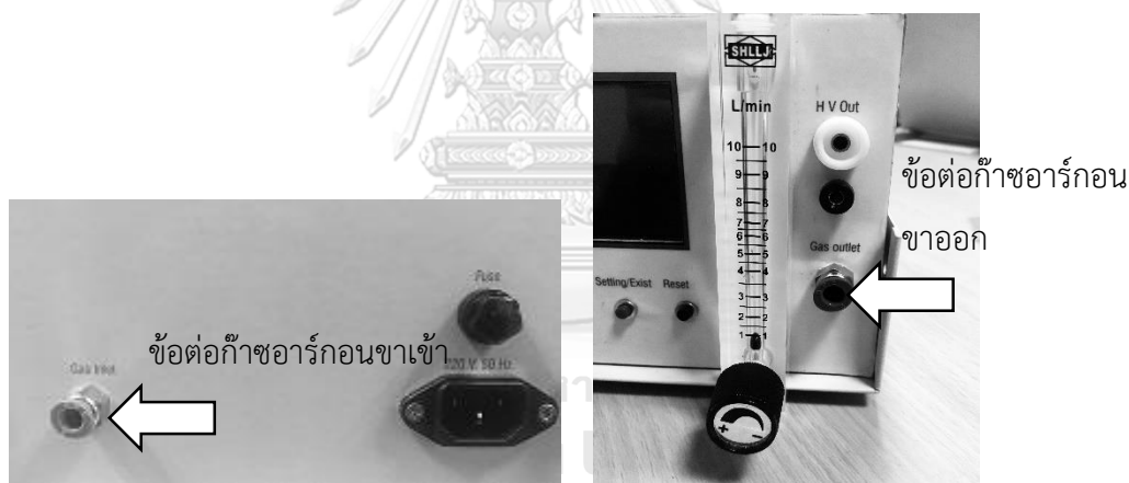
รูปที่ 3. 13 โครงสร้างชุดควบคุมอัตราการไหลของก๊าซ
