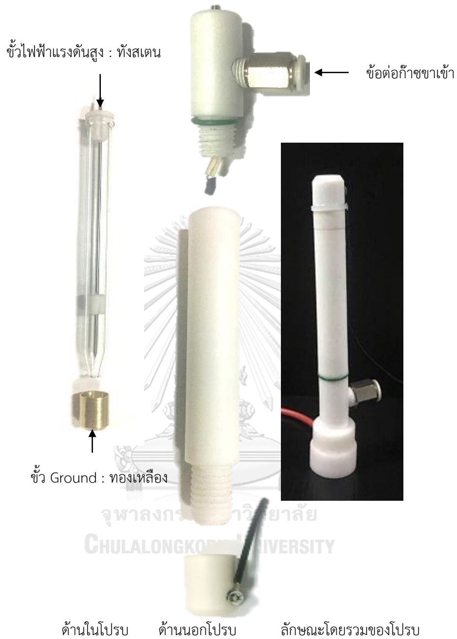
รูปที่ 3. 12 โครงสร้างของโพรบสำหรับกำเนิดลำพลาสมา
